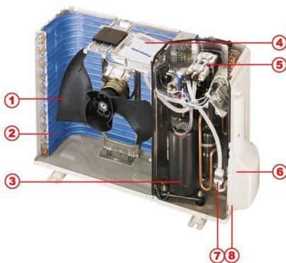
1. **Вентилятор** — создает поток воздуха, обдувающего конденсатор. В недорогих моделях вентилятор имеет только одну скорость вращения. Такой кондиционер может стабильно работать в небольшом диапазоне температур наружного воздуха.
