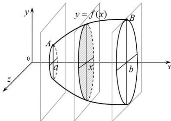
Сечения такого тела плоскостью  $x = const$  представляет собой круг с площадью, равной  $S(x) = \pi y^2 = \pi (f(x))^2$ , и формула для вычисления в этом случае имеет вид
