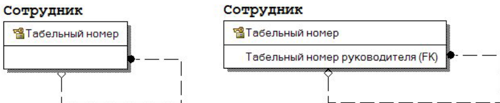
Рис. 8. Примеры реализации рекурсивных отношений с использованием имени роли и без него в сущности Сотрудник
