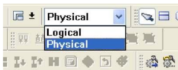
Рис. 3. Переход к физической модели через пункт Physical панели инструментов
