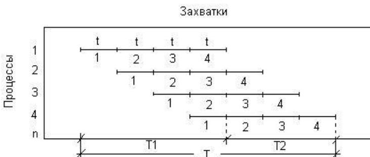
Рис 5.6 График ритмичного потока
