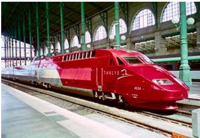
Рисунок 1.18 - Высокоскоростной поезд Thalys с концевыми моторными вагонами
