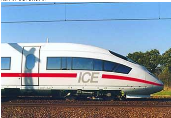
Рисунок 1.19 - Поезд ICE3 с распределенной тягой
