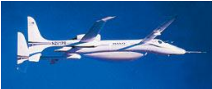
Рисунок 1.13 - Многоцелевой беспилотный летательный аппарат "Протеус" производства США
