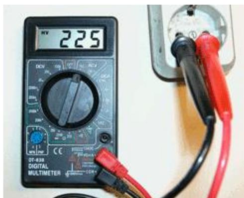
Рисунок 4 – Измерение напряжения электрической сети
