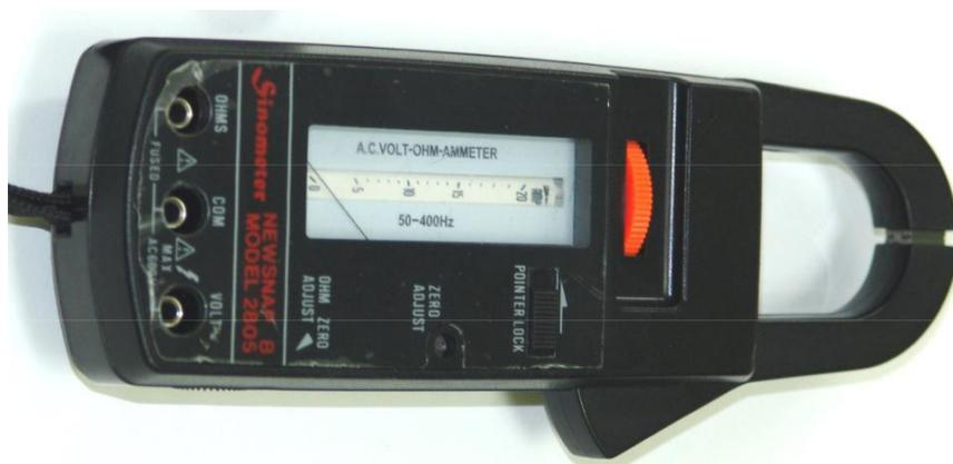
Рис. 2. Клещи мультиметр модели 2805
