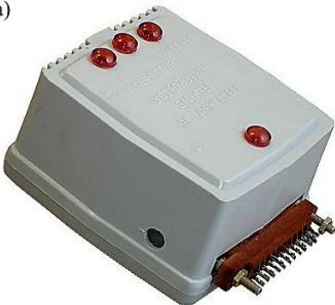
а) Внешний вид: светодиоды, сигнализирующие (слева направо) об обрыве фазы, перегрузке, перегреве (вверху), о включении устройства (внизу). Слева отверстие для регулирования времени нечувствительности к пусковым перегрузкам.
