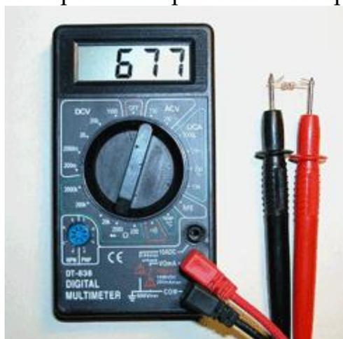
Рисунок 5 – Измерение сопротивления
