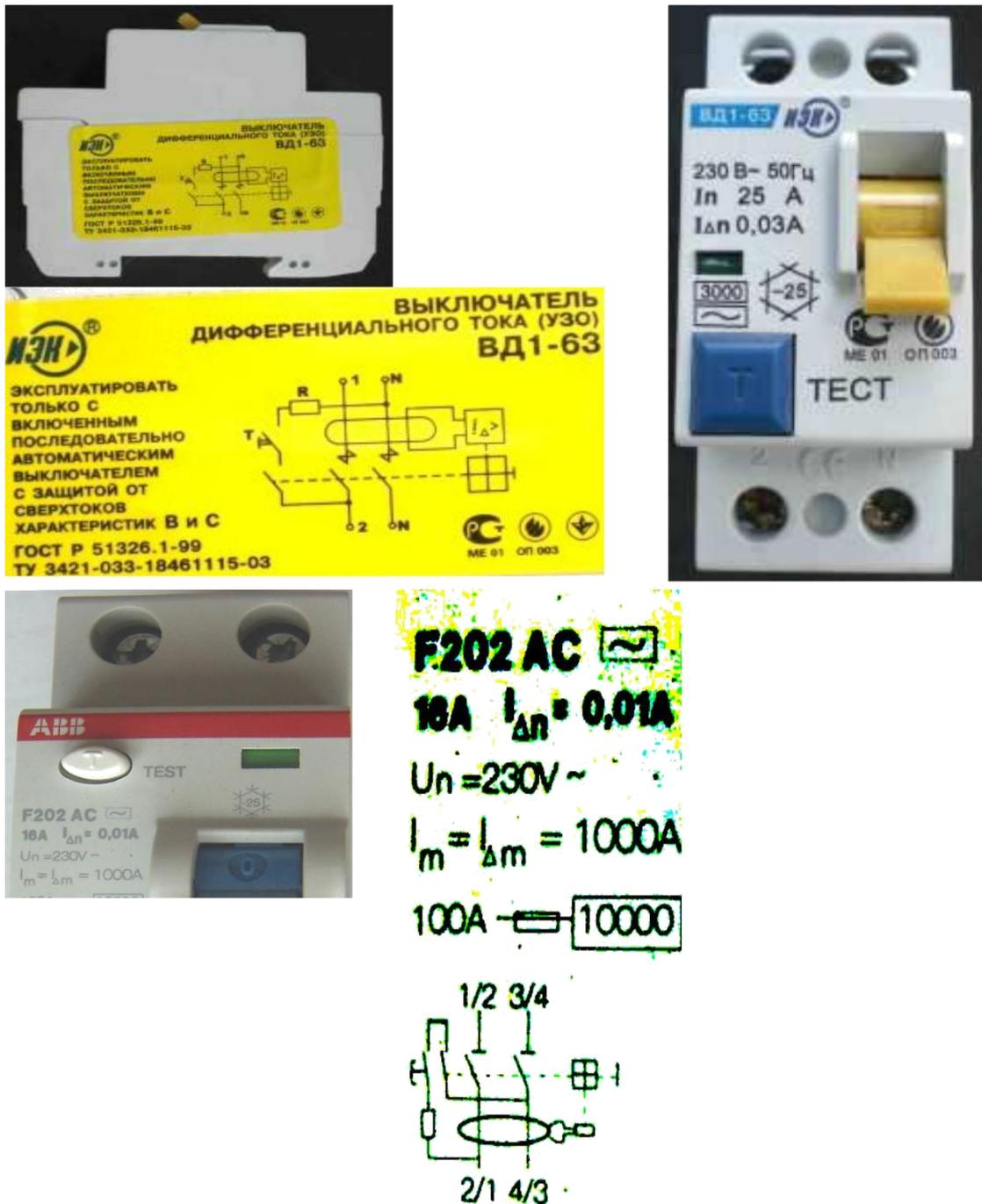
Рис. 6. Отечественное УЗО ВД1-63 (вверху) и концерна АВВ (Италия) Исполнительный механизм и электромагнитный расцепительодинаковы по механическому устройству. Отличие их в количестве витков и диаметре провода катушки расцепителей.
