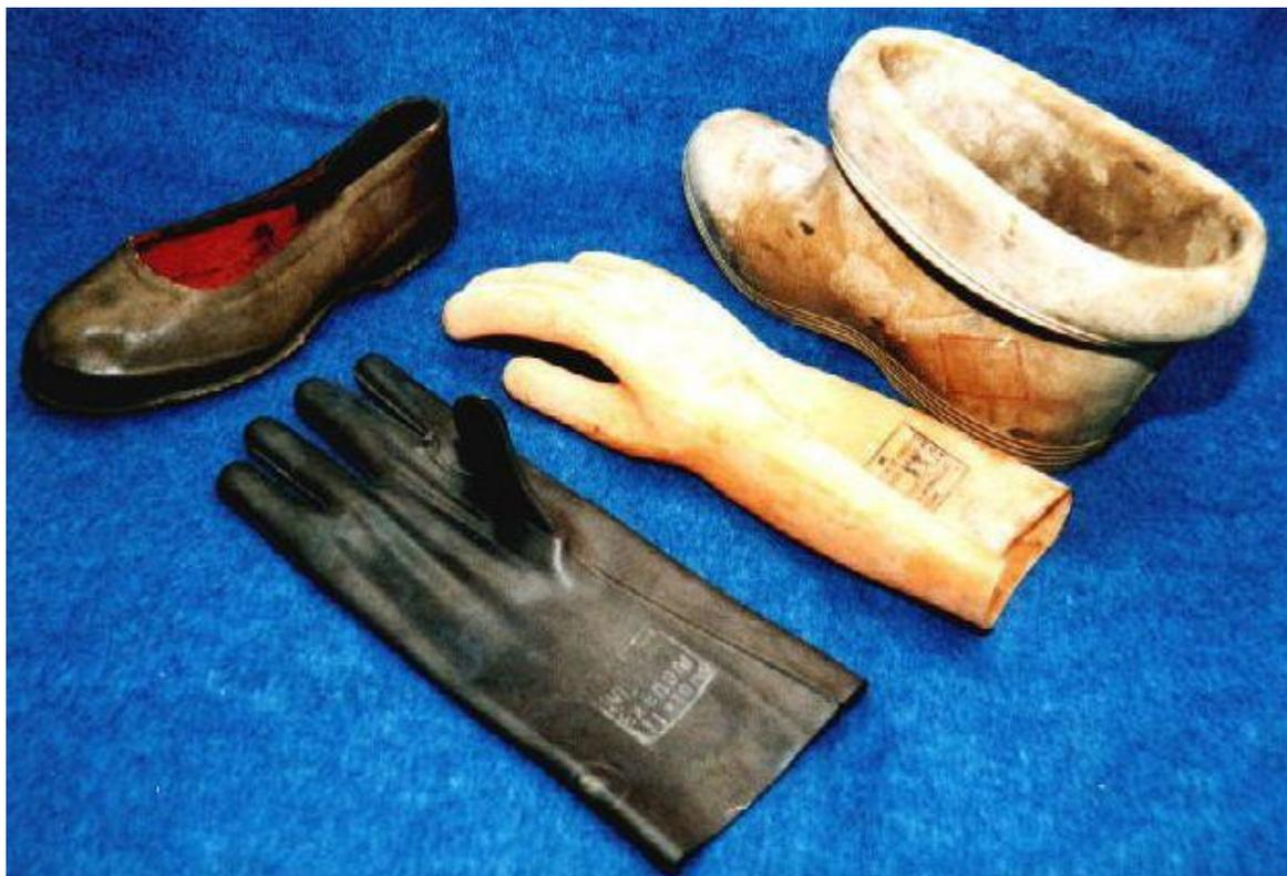
Рис. 1. Диэлектрические перчатки, галоша, бот
