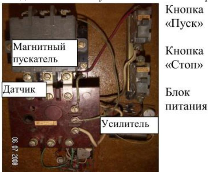
Рис. 3. Устройство ЗОУП-25
