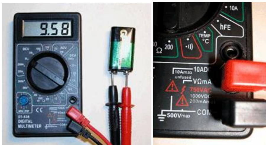
Рисунок 3 – Измерение напряжения батарейки
