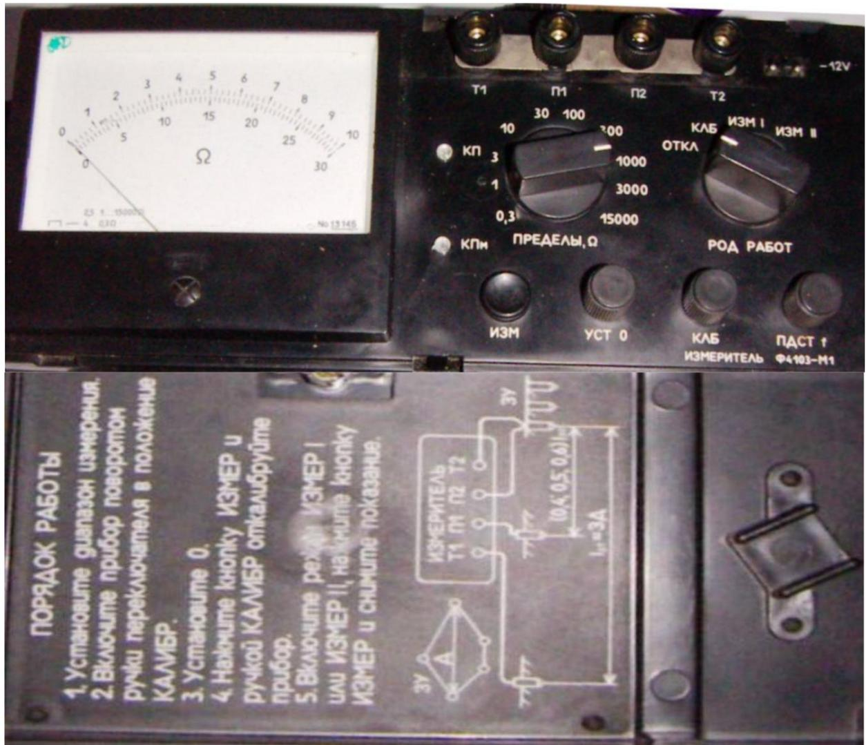
Рис. 3. Общий вид прибора Ф4103-М1(вверху) и крышки прибора – вид изнутри (внизу)
