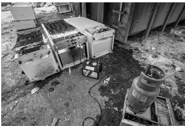
Рис. 3.4. Фото откачки фреона
