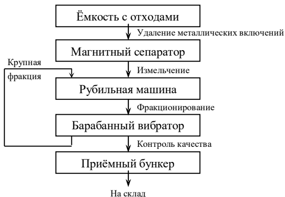
Рис. 4.2. Технологическая схема производства щепы
