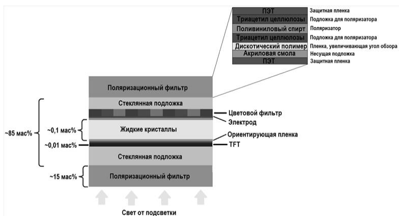
Рис. 3.16. Упрощённое схематическое изображение строения ЖК-дисплея
