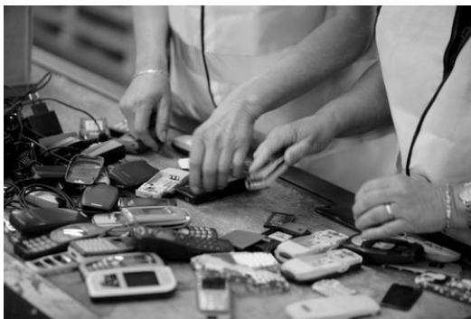
Рис. 3.30. Ручная разборка сотовых телефонов
