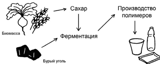
Рис. 6.5. Схема получения биоразлагаемого полимера
