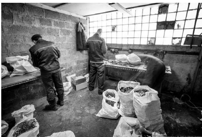
Рис. 3.10. Фото извлечения отдельных комплектующих компьютерной техники
