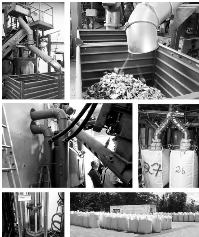
Рис. 3.26. Процесс измельчения корпуса холодильника
