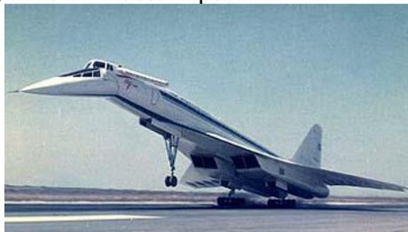
Рисунок 5.1 - Сверхзвуковой самолет ТУ-144
