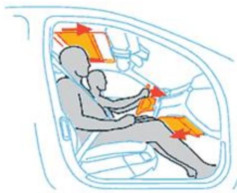
в критической ситуации система закрывает люк, придвигает рулевое колесо ближе к водителю, а специальную коленную панель – к переднему пассажиру
