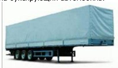
Рисунок 1.2 - Полуприцеп тентованный
