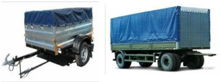
Рисунок 1.1 - Прицеп легкового автомобиля и прицеп бортовой с тентом
