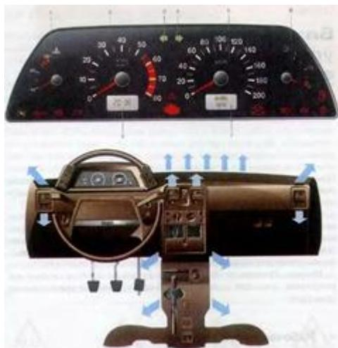
Рисунок 5.11 – Органы управления автомобиля и комбинация приборов: 1 – указатель температуры охлаждающей жидкости, 2 – тахометр, 3,4 – контрольная лампа указателей левого и правого поворотов, 5 – спидометр, 6 – указатель уровня топлива, 7 – счетчик пройденного пути, 8 – часы.
