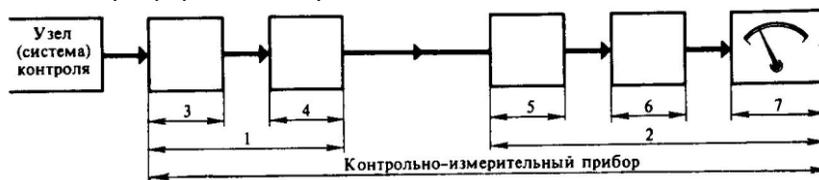
Рисунок 6 - Структурная схема контрольно-измерительного прибора (указателя): 1-датчик, 2-приемник, 3-чувствительный элемент датчика, 4-преобразователь сигнала в датчике, 5-чувствительный элемент приёмника, 6-преобразователь сигнала в приёмнике, 7-шкала показаний приёмника.
