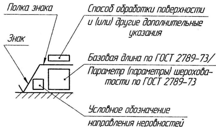
Рисунок 8 - Структура знака изображения шероховатости поверхности детали на чертеже.
