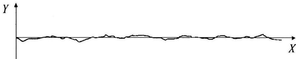
Рисунок 5 - Истинный профиль шероховатости поверхности при его многократном увеличении
