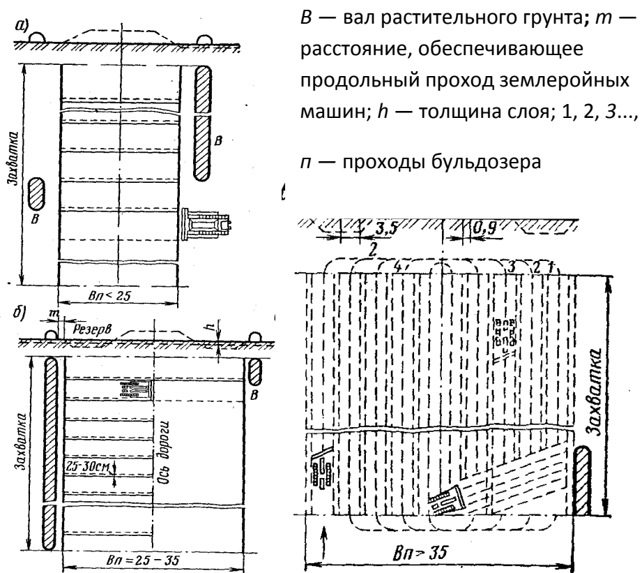
Рисунок 2 - Схемы снятия растительного грунта
