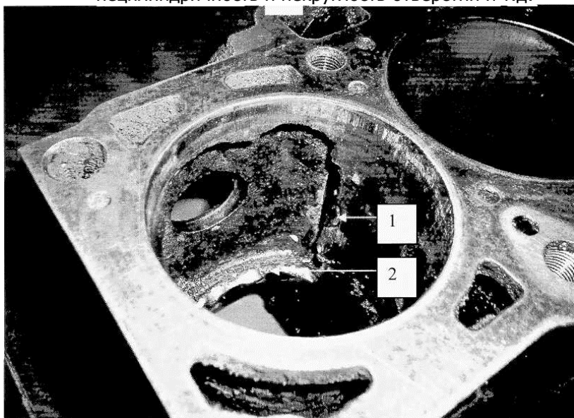
Рисунок 3 - Дефекты гильзы цилиндра: 1-трещина, 2-облом гильзы
