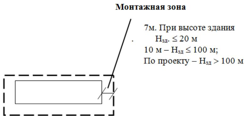
Рис.8.7. Опасная зона вблизи строящегося здания или сооружения
