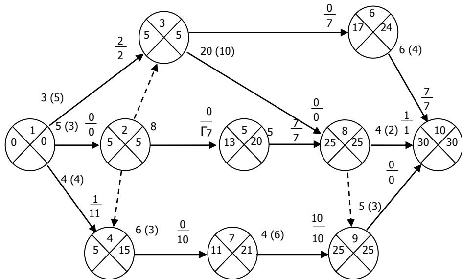
Рис. 6.2. Расчет сетевого графика секторным методом: над стрелкой указаны продолжительность работы, численность рабочих (в скобках), через дробь – резервы времени
