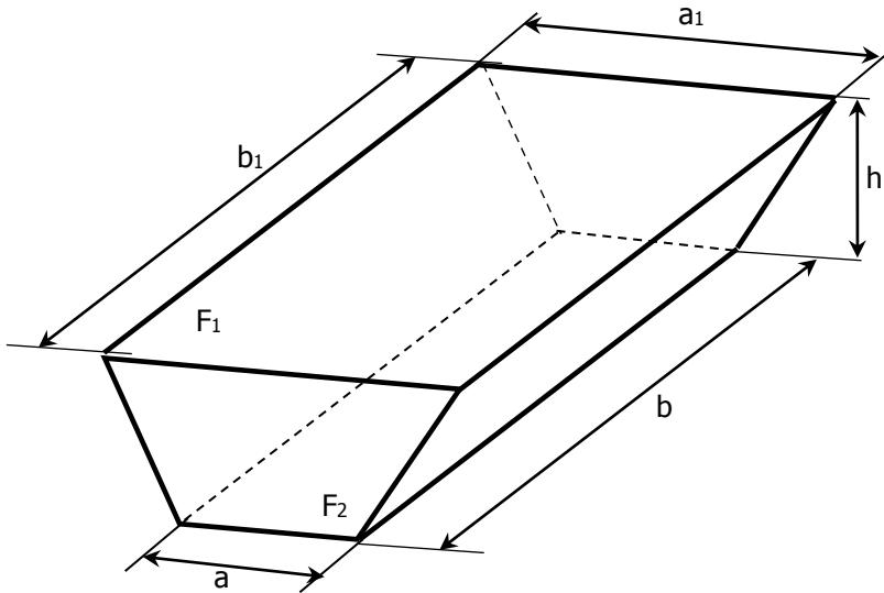
Рис. 3.7. Схема для определения объема котлована
