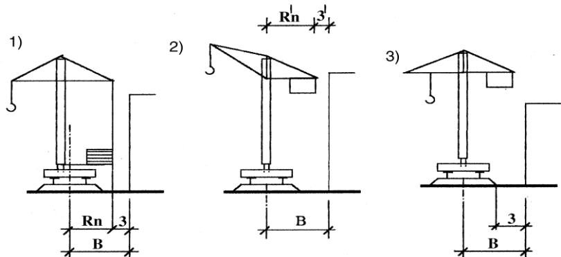
Рис.8.5. Схема привязки подкрановых путей башенного крана у здания
