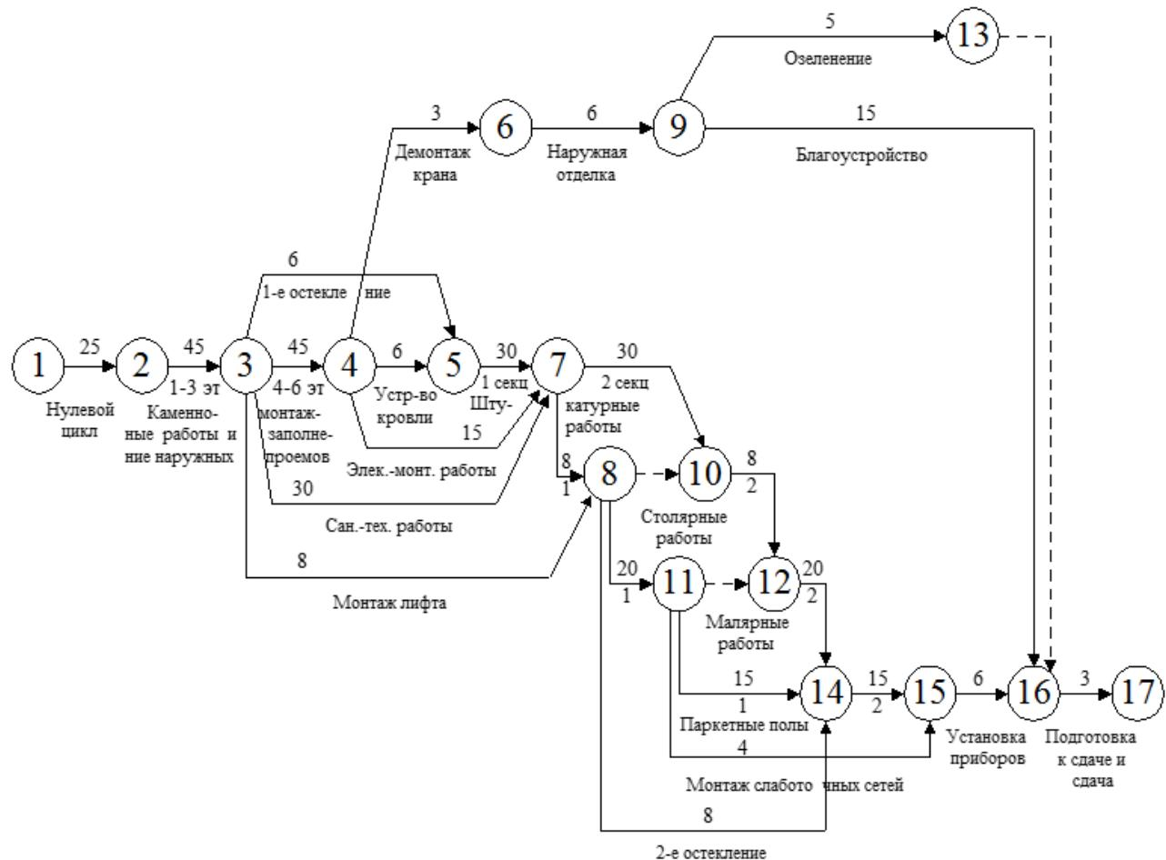
Рис. 5.6. Укрупненный сетевой график строительства жилого дома
