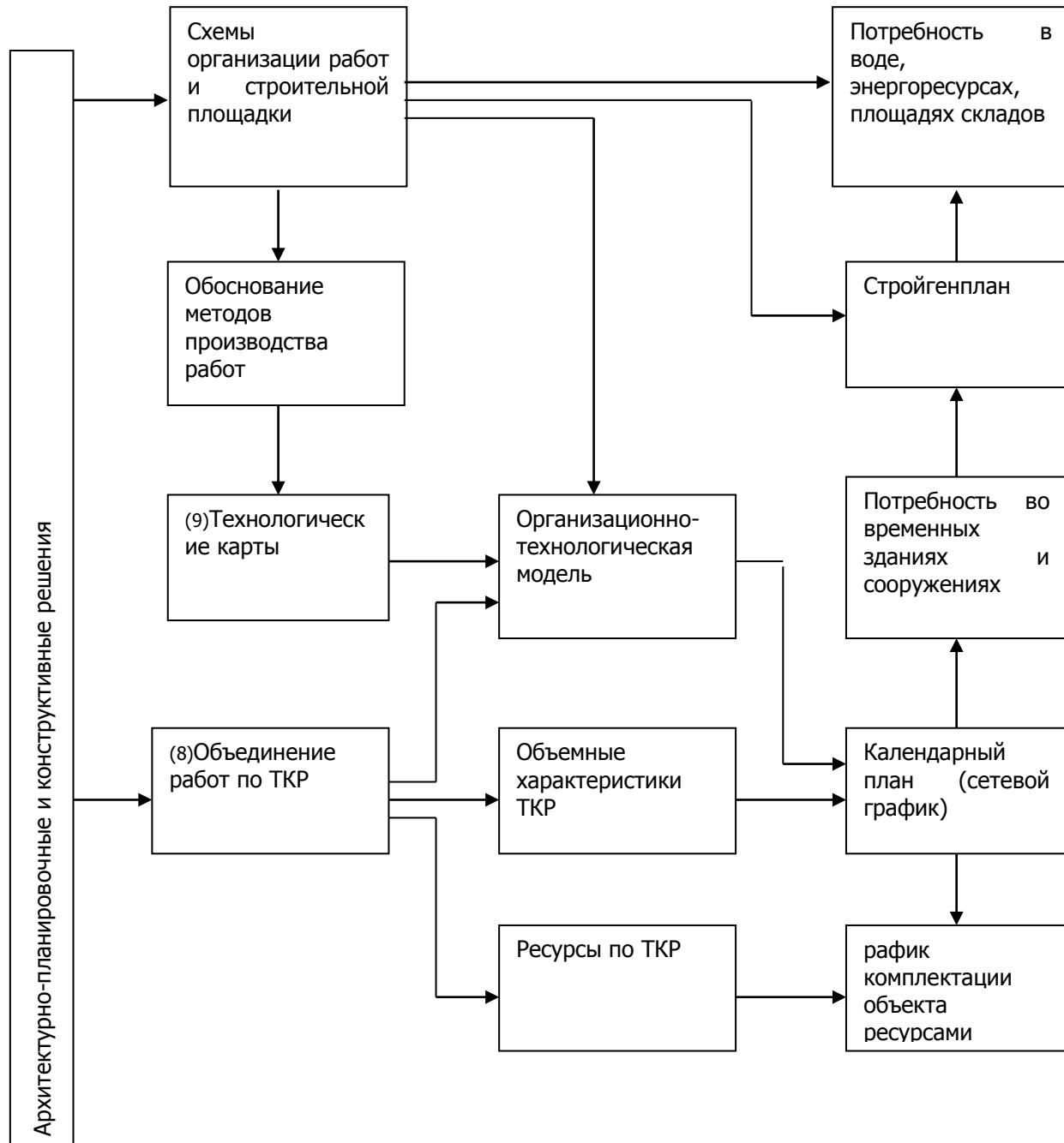
Рис. 1.2. Взаимосвязь и последовательность организационно-технологического проектирования на стадии разработки ППР
