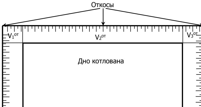
Рис. 3.8. План котлована в торце
