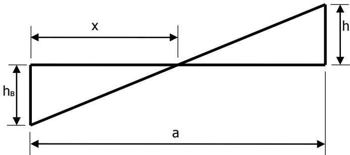
Рис. 3.2. Определение положения линий нулевых работ
