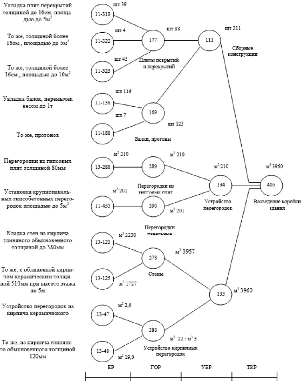
Рис. 5.1. Преобразование информации из сметы при многоуровневой агрегации
