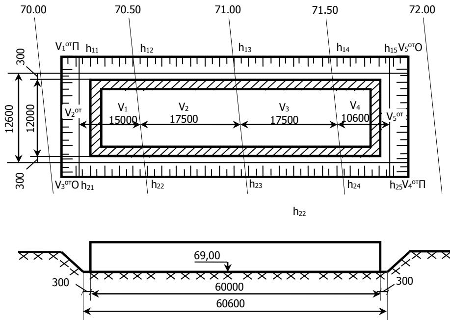
Рис. 3.10. План и разрез котлована с указанием основных параметров для подсчета объема грунта
