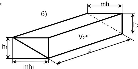
Рис. 3.9. Геометрические фигуры, по которым ведется подсчет объемов откосов
