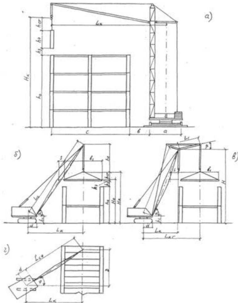
Рис. 9.1. Схемы для определения требуемых технических параметров монтажного крана: а – башенного; б – самоходного без гуська; в – с гуськом; г – без гуська с поворотом в плане
