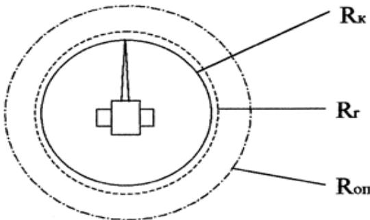
Рис. 8.9. Опасная зона работы монтажного крана
