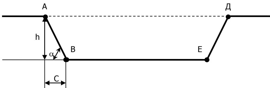
Рис. 3.5. Элементы выемки
