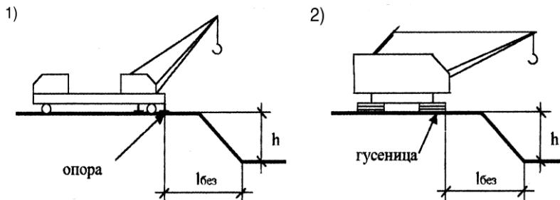
Рис. 8.4. Схема привязки самоходных кранов вблизи котлованов и траншей: 1 – пневмоколесный; 2 – гусеничный
