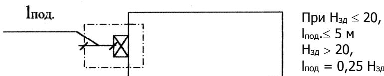
Рис. 8.10. Зона работы подъемника
