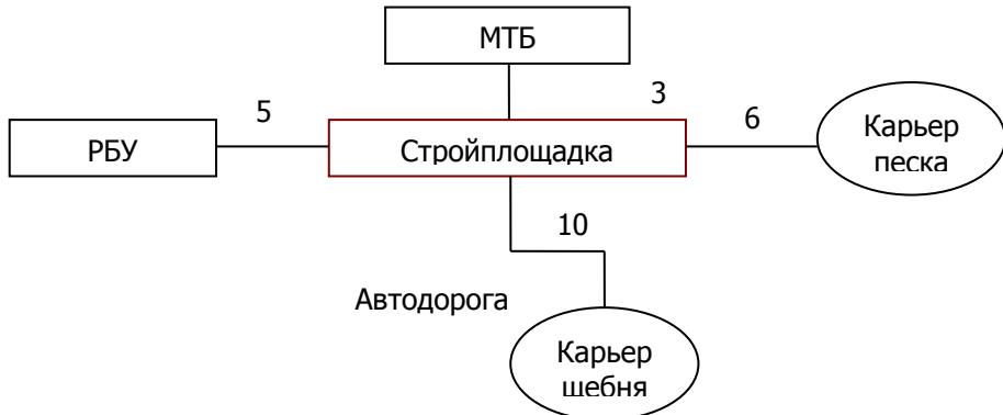
Рис. 8.1. Фрагмент ситуационного плана строительства
