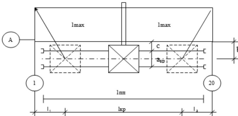
Рис. 8.6. Схема продольной привязки башенного крана и подкрановых путей к зданию
