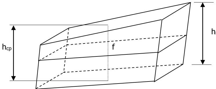
Рис. 3.3. Схема для определения объема грунта при вертикальной планировке
