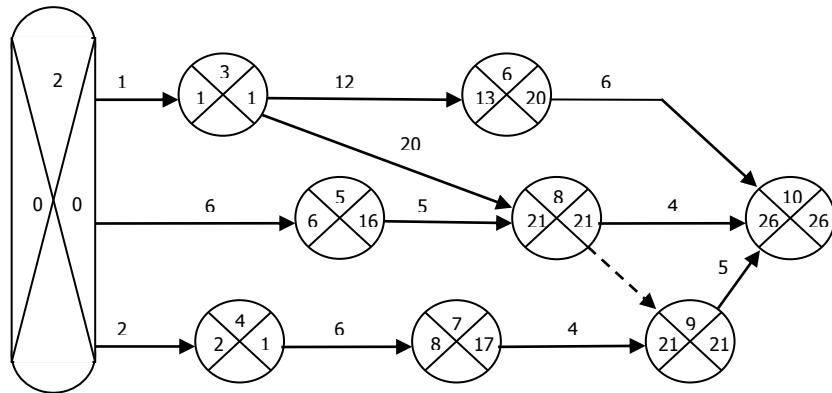
Рис. 6.5. Откорректированный сетевой график
