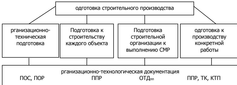
Рис. 1.1. Организационно-техническая документация, разрабатываемая на этапах подготовки строительного производства
