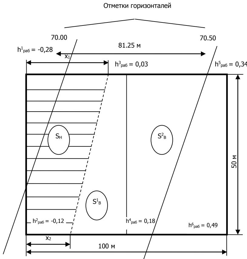
Рис. 3.4. Разбивка участка планировки на квадраты при подсчете объемов работ
