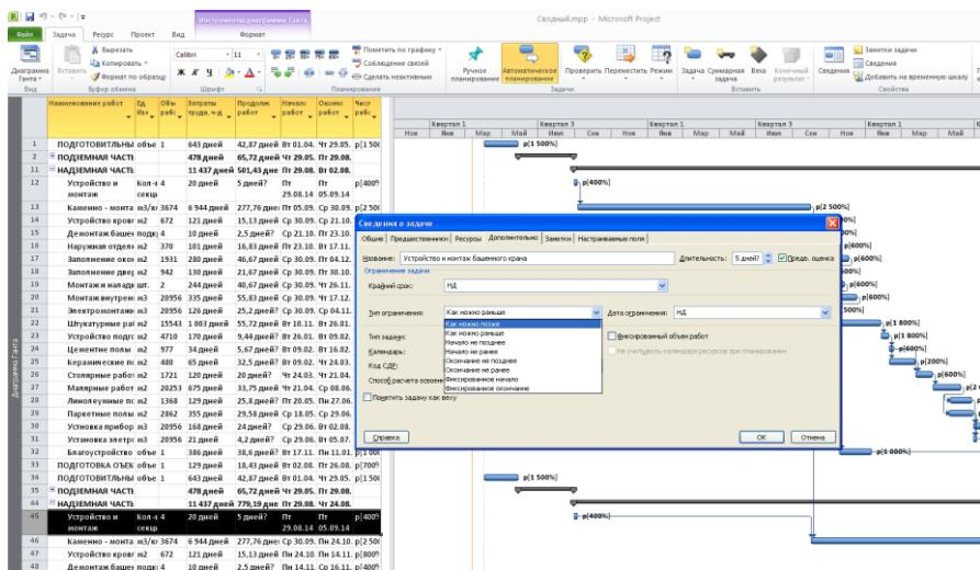
Рис.16. Снятие перерыва между двумя смежными работами
