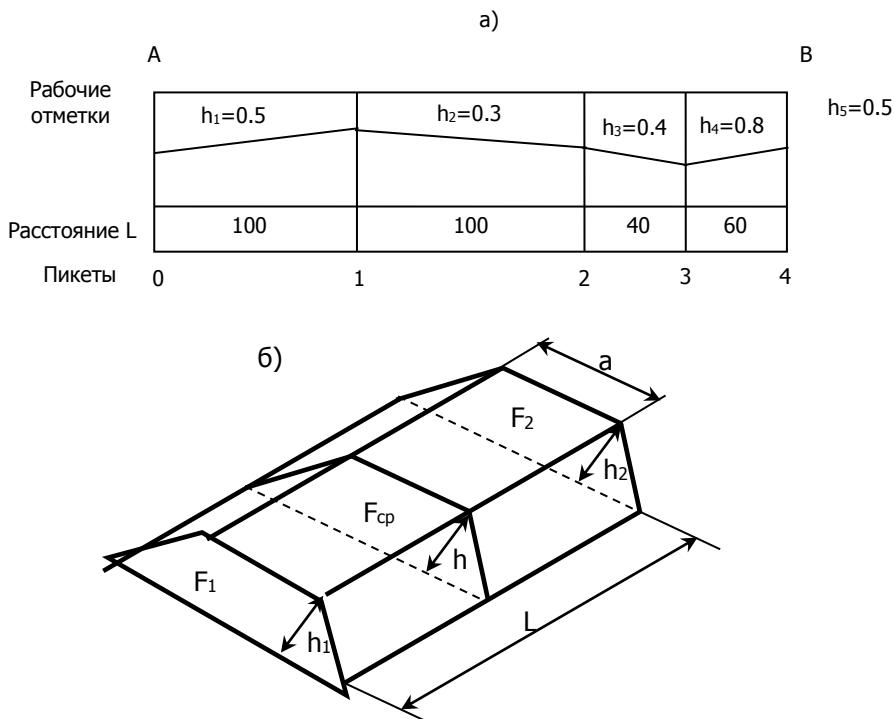
Рис. 3.11. Схема продольного профиля земляного полотна и общий вид насыпи: а – продольный профиль; б – общий вид насыпи на участке между пикетами 0 и 1
