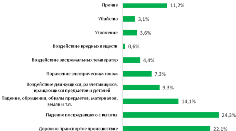
Рис. 1.4. Структура видов происшествий, приведших к несчастному случаю со смертельным исходом, в строительстве (% от общего количества смертельных несчастных случаев)
