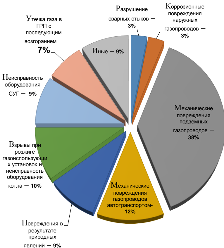
Рисунок 3.2 – Основные виды аварий газораспределительных систем, %.
