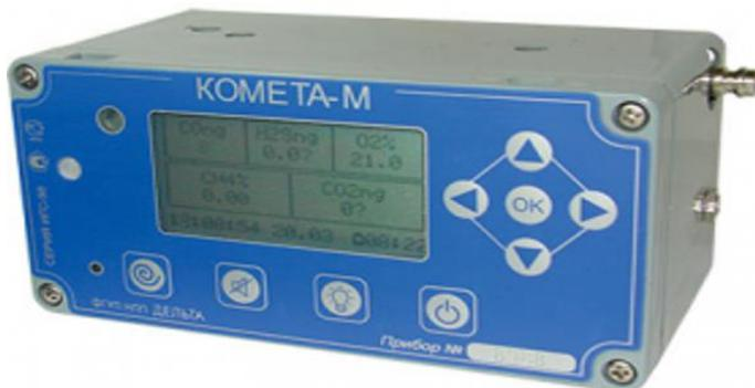
Рис. 4.1. Газоанализатор Комета
