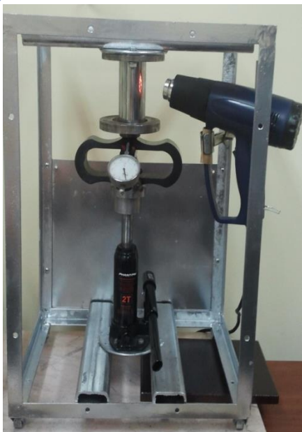
Рисунок 1 - Установка для определения огнестойкости силовых конструкций
