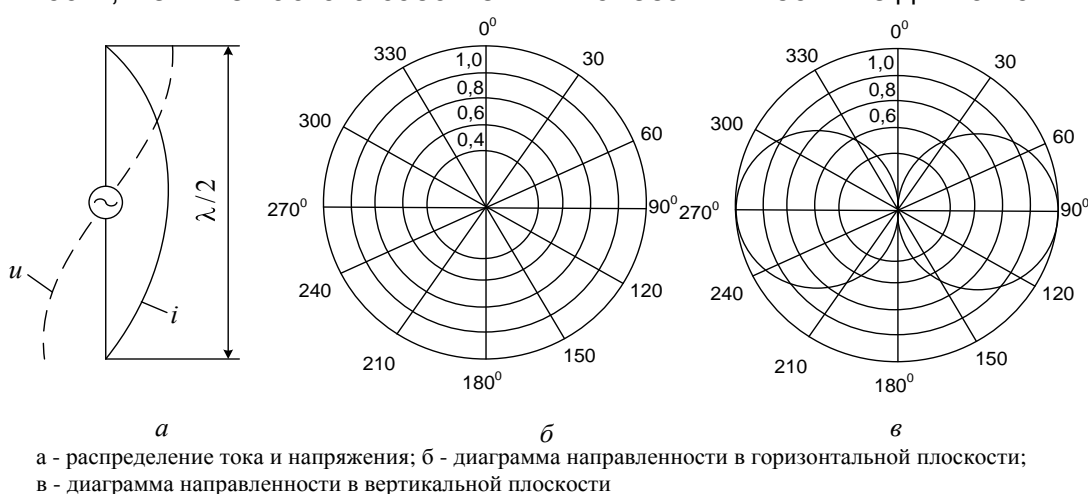
Рис .1. Направленность полуволнового вибратора
