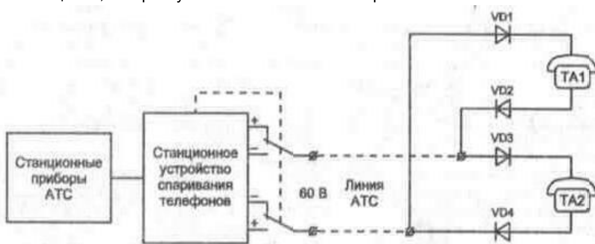
Рис. 1.6. Схема подключения спаренных телефонов.
