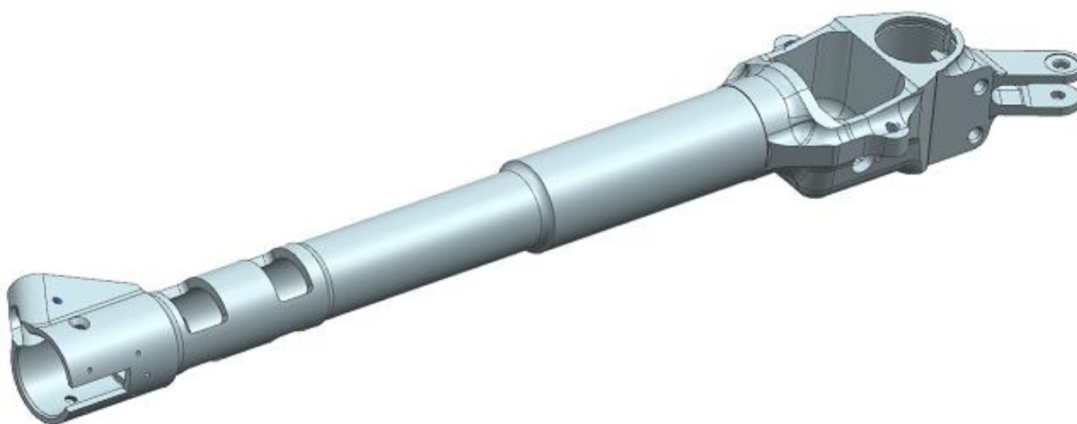
Рис. 2.7 Корпус (АК6, габарит 520×60×80)
