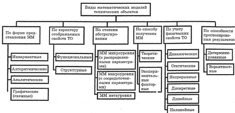
Рис. 1.2. Классификация математических моделей (ТО - технический объект)
