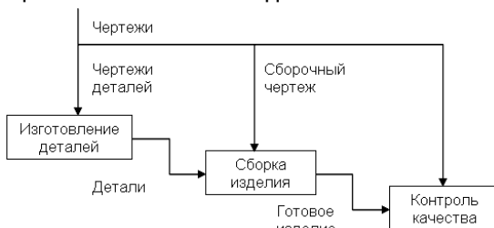
Рис. 1.7. Структурная модель процесса изготовления изделия
