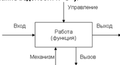
Рис. 1.4. Элементы графической нотации IDEF0
