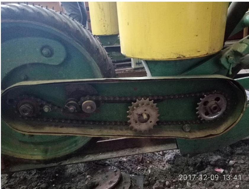
привод высевающего аппарата
