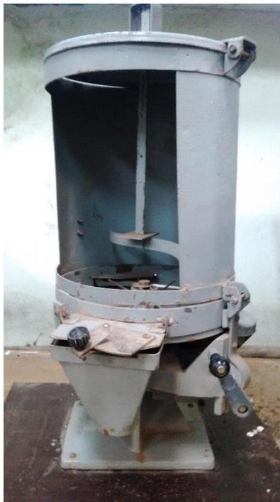
Рисунок 1 – Общий вид туковысевающего аппарата АТД-2
