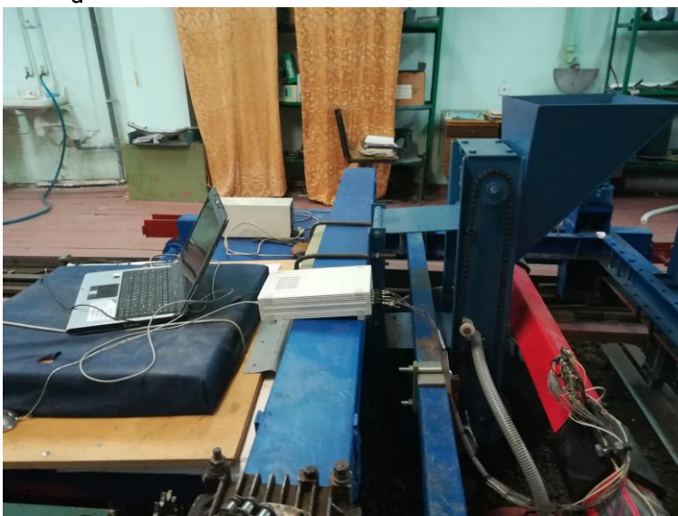
Рисунок 3. Рабочий орган на тележке с аппаратурой; а – крепление рабочего органа на тензобрусе; б - измерительный комплекс на тележке
