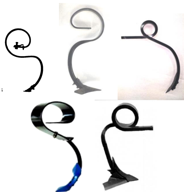
Рис.2. Стандартные стойки культиваторов по ГОСТ 1343—76
