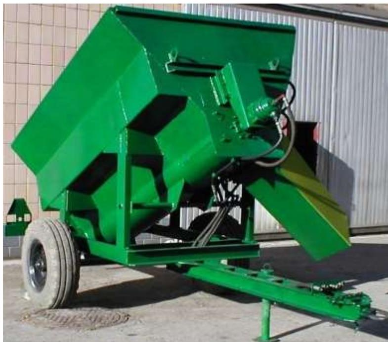
Рисунок 95 – Общий вид прицепного смесителя-раздатчика концентров с мелассой и другими балансирующими добавками
