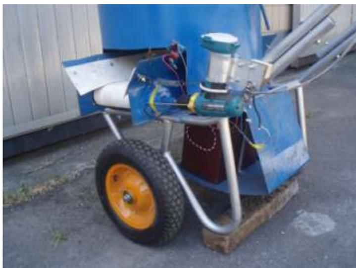
Рисунок 54 – Электропривод раздатчика
