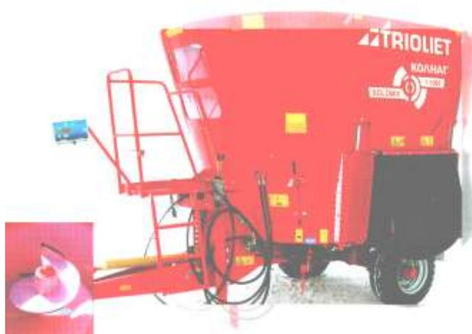
Рисунок 4 – Одношнековый смеситель кормораздатчик TRIOLIET SOLOMIX 10 ZK с бункером вместимостью 10 м<sup>3</sup>
