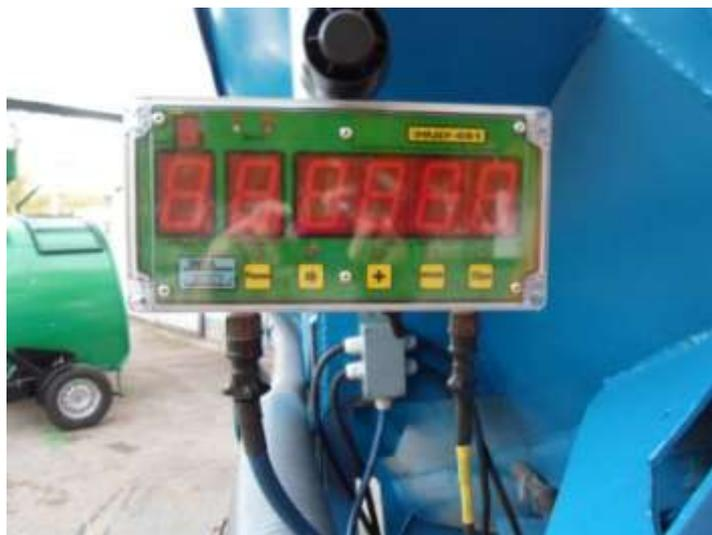
Рисунок 38 – Электронный блок весового устройства
