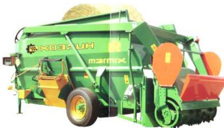
Рисунок 6 – Измельчитель-смеситель-раздатчик кормов ИСРК-12 «Хозяин»
