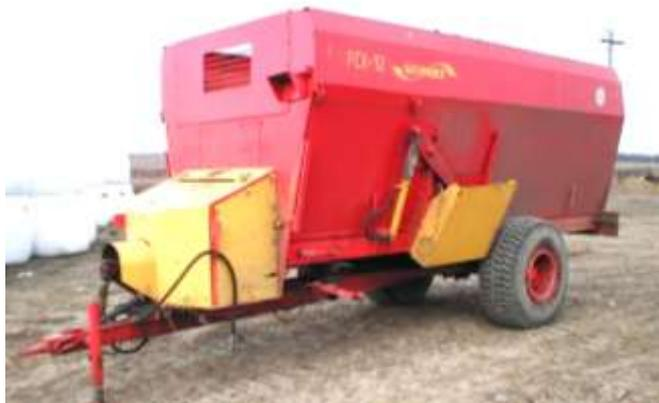
Рисунок 7 – Измельчитель-смеситель-раздатчик кормов РСК-12 «Белмикс»
