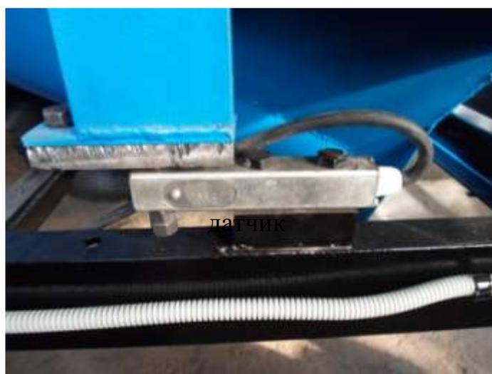
Рисунок 37 – Датчик силы электронного весового устройства
