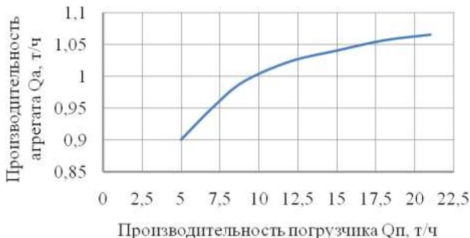
Рисунок 48 – Зависимость производительности агрегата от производительности погрузчика зерновых кормов
