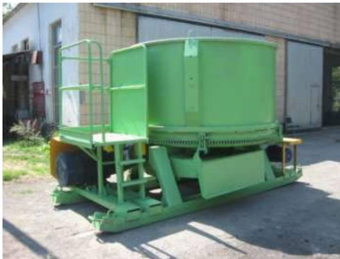
Двухшнековый агрегат кормовой многофункциональный с вместимостью бункера 14-16м<sup>3</sup>
