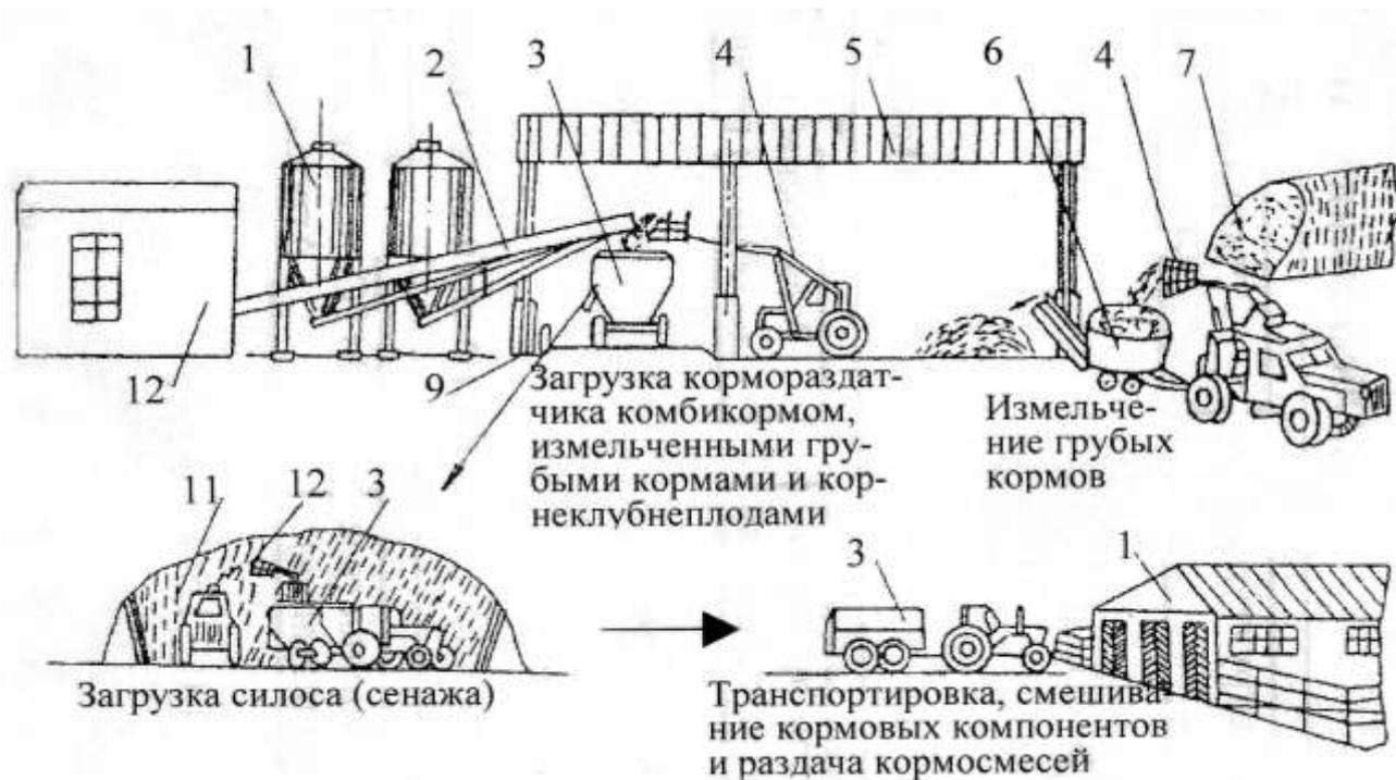
Рисунок 102 – Технологическая схема приготовления и раздачи кормосмесей на крупных фермах КРС:
