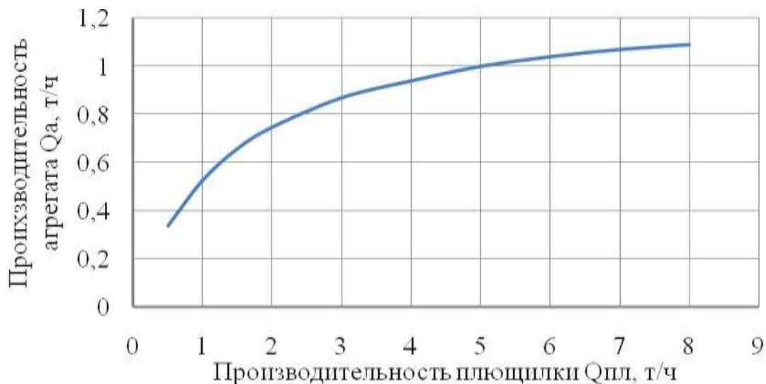
Рисунок 50 – Зависимость производительности агрегата от производительности плющилки
