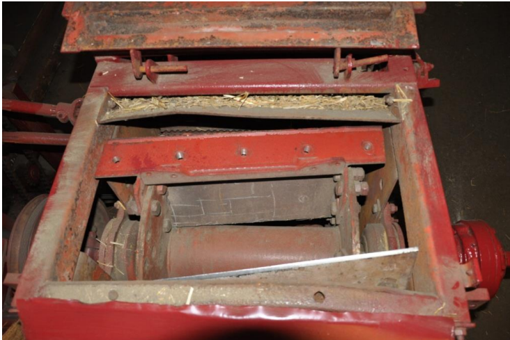
Измельчитель (кормоуборочный комбайн ДОН-680, фрагмент)
