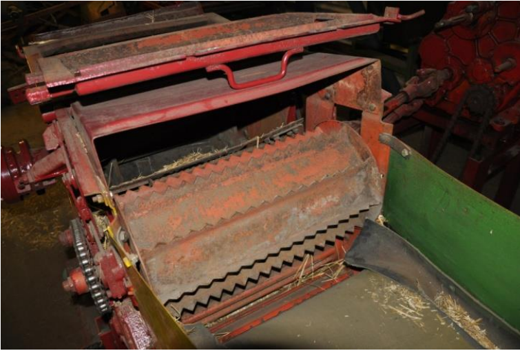
Лабораторная установка по оценке качества дробления с/х материалов.
