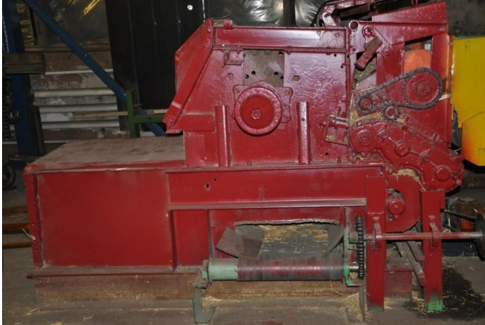
Измельчитель (кормоуборочный комбайн ДОН-680, фрагмент)
