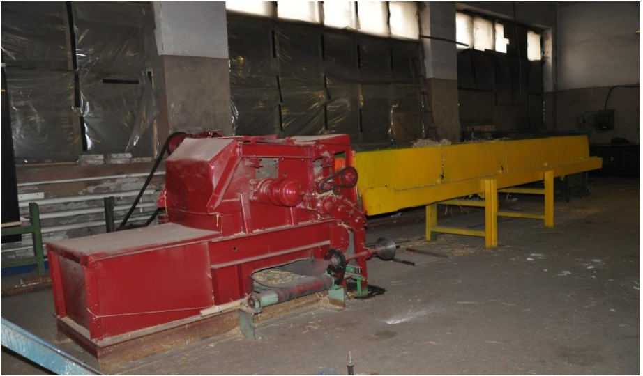
Лабораторная установка по оценке качества измельчения с/х материалов.
