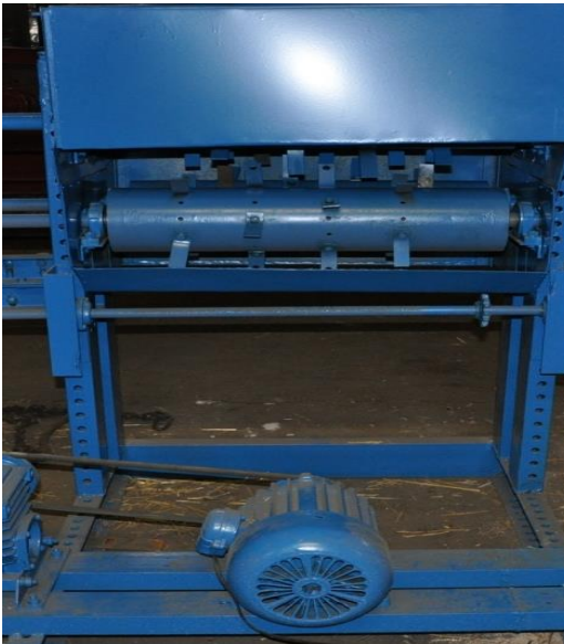
Лабораторная установка по оценке качества дробления с/х материалов.
