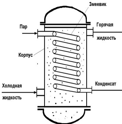
Рисунок 13.2.3 - Погружной змеевиковый теплообменный
