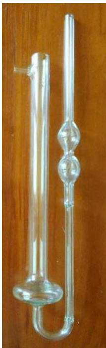
Рисунок 2 – Вискозиметр ВПЖ-4: общий вид (а) и схема (б).
