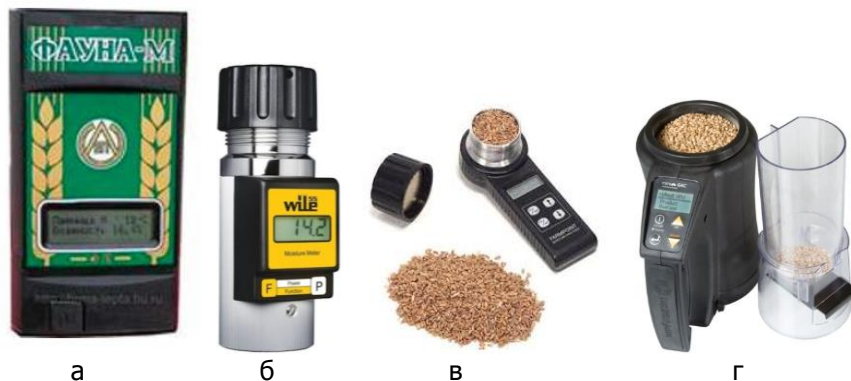
Рисунок 6.3 – Экспресс-влагомеры: а – «Фауна-М», б - WILE-55, в – Farmpoint, г - mini GAC
