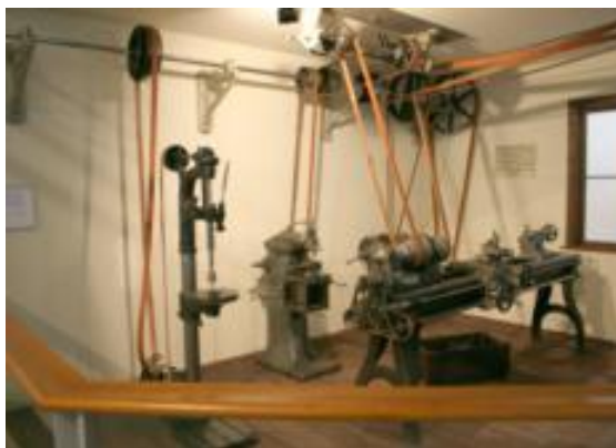
Рис.ПЗ.3.26. Вид трансмиссии с общим валом и ременными передачами к отдельным станкам (Венский Технический музей)
