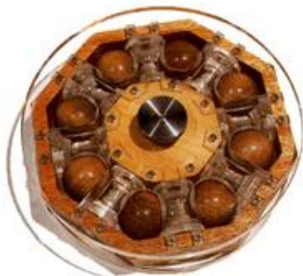
Рис.ПЗ.3.21. Чертеж и макет подшипника конструкции Леонардо да Винчи
