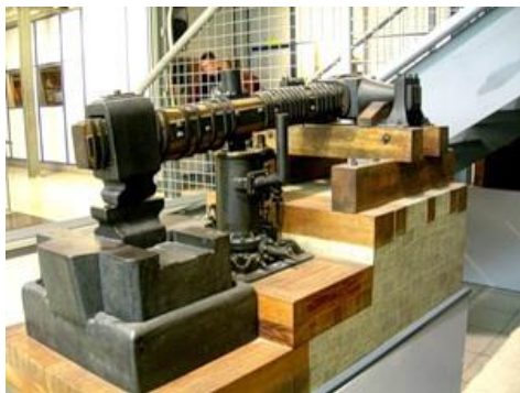
Рис. ПЗ.3.8. Молоты XVIII века: 1 – с кривошипно-шатунным механизмом (музей Уральского горного института); 2 – с кулачковым приводом (Немецкий музей техники, г. Мюнхен)
