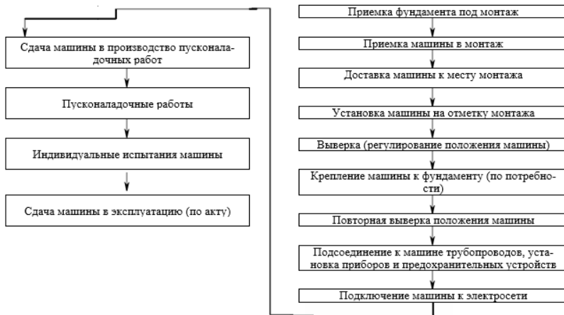
Рис.1.1.2. Схема технологических операций, выполняемых субподрядчиками
