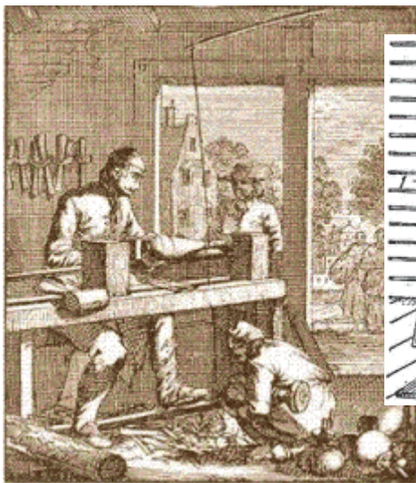
Рис. ПЗ.3.15. Средневековый токарный станок с оцепом (гибкой жердью)
