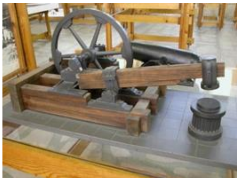
Рис. ПЗ.3.8. Молоты XVIII века: 1 – с кривошипно-шатунным механизмом (музей Уральского горного института); 2 – с кулачковым приводом (Немецкий музей техники, г. Мюнхен)
