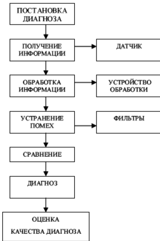
Рис.2.4.17. Алгоритм диагностирования машин по спектральному частотному сигналу шума
