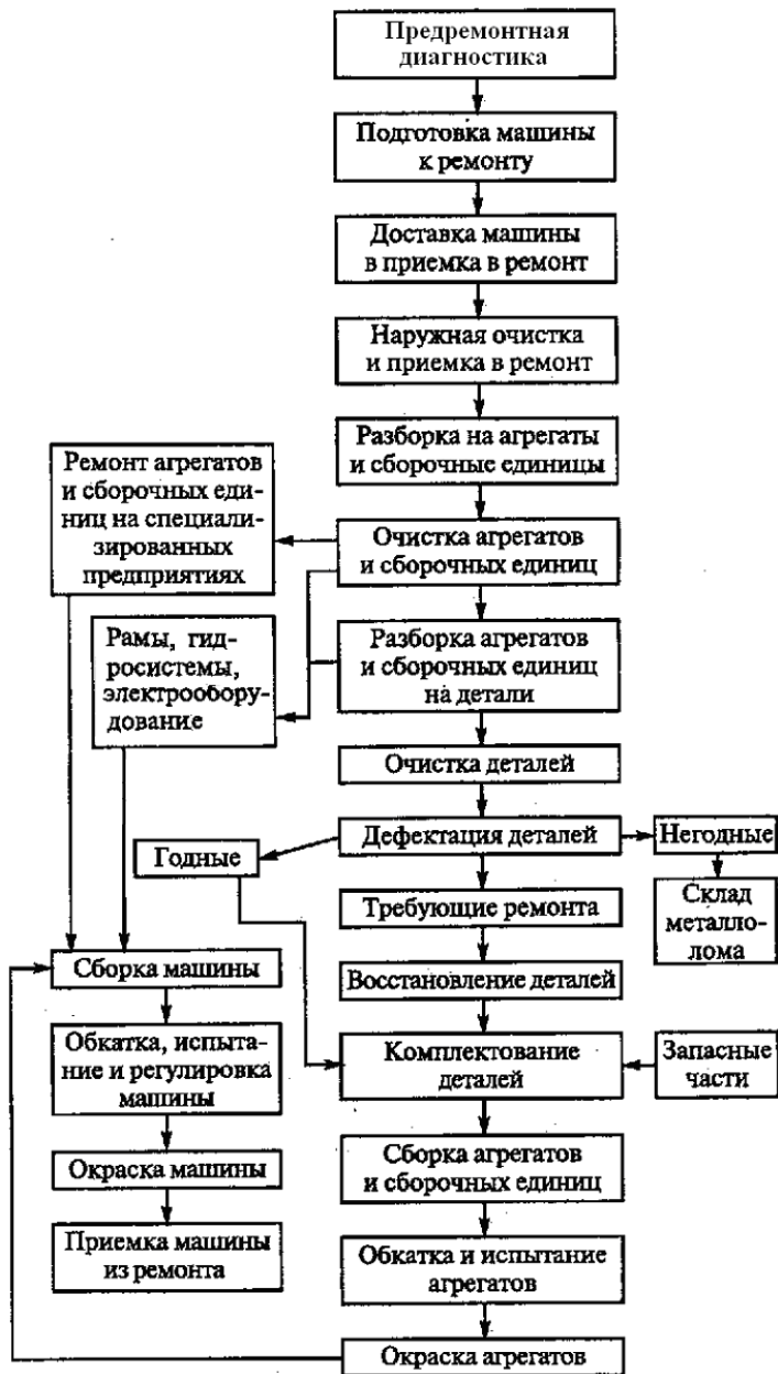
Рис. 3.2.1. Схема технологического процесса капитального ремонта машин
