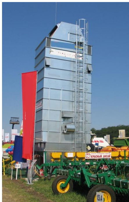
Рис. 3.4.12. Внешний вид шахтной зерносушилки Наибольшее распространение получили рециркуляционные шахтные сушилки с противоточными камерами нагрева (рис. 3.4.13).
