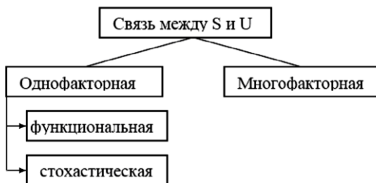
Рис.2.4.5. Классификация связей между структурными и диагностическими параметрами (U- структурный параметр, S – диагностический)
