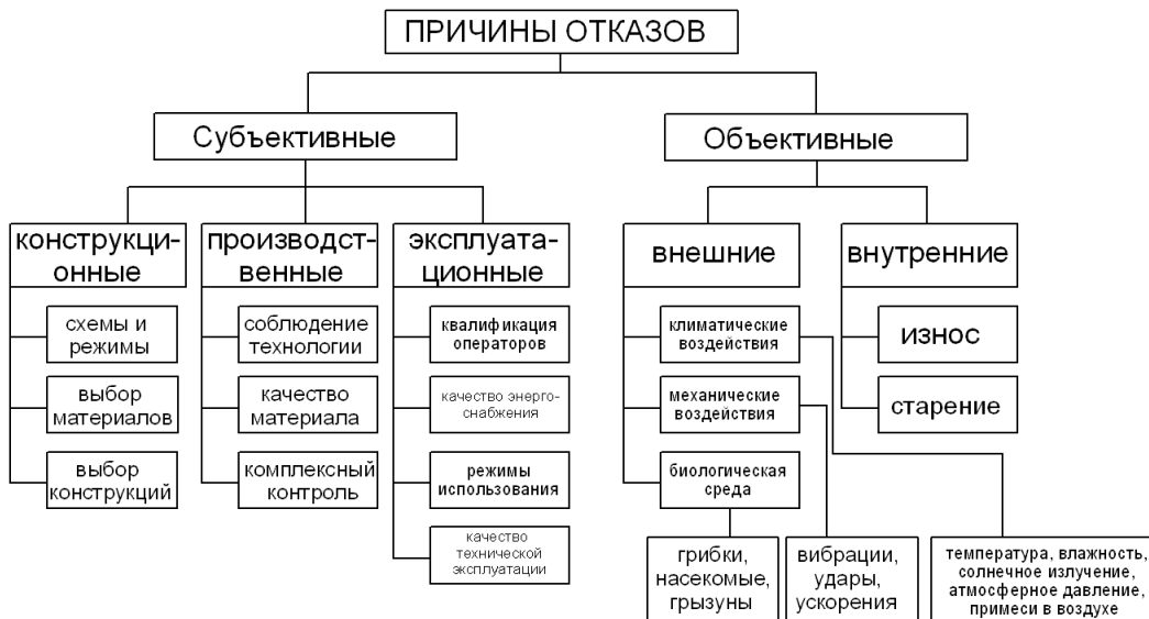
Рис.2.2.1. Классификация причин отказов машин
