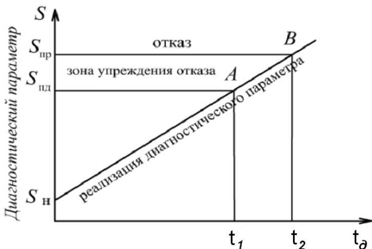
Рис.2.4.9. Формирование диагностических нормативов: t_d – периодичность диагностирования
