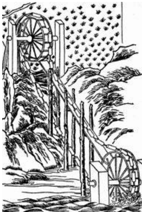
Рис.ПЗ.3.24. Водоподъемник цепной
