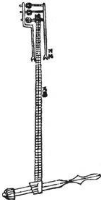
Рис.3.3.25. Самая старая известная иллюстрация замкнутой цепной передачи, изданная Су Суном
