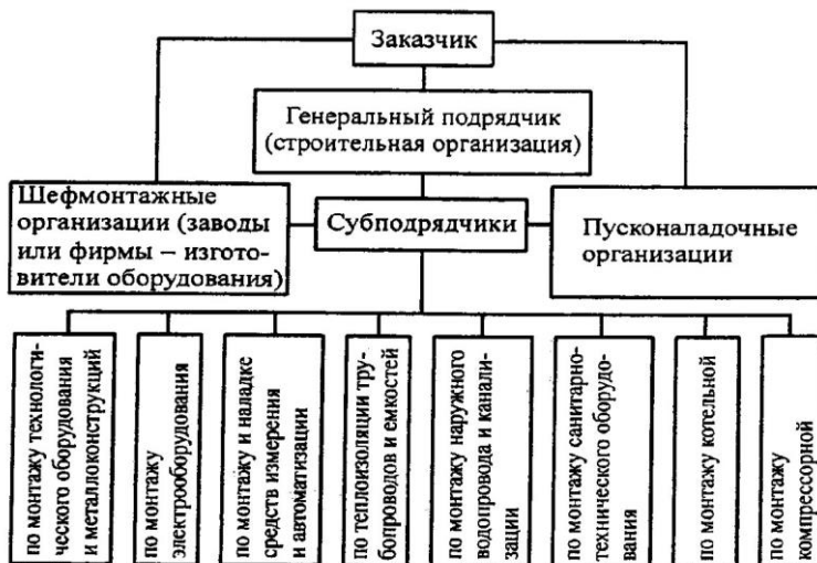
Рис.1.1.1.1. Схема взаимосвязи заказчика и подрядчиков при организации строительных, монтажных и специальных работ подрядным способом
