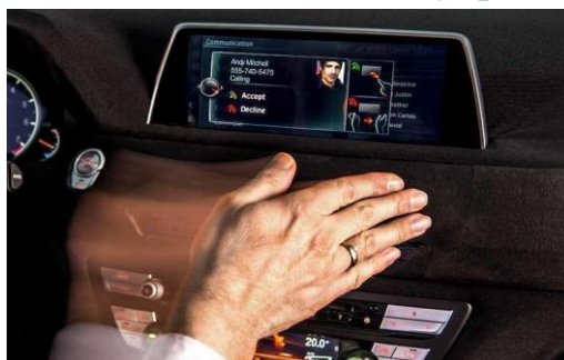
Рисунок 7 – Жестовое управление бортовой навигационной системой на автомобиле BMW
