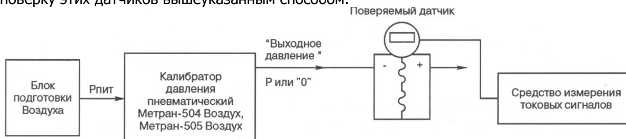
Рис.9. Схема подключения калибраторов Метран-504 Воздух, Метран-505 Воздух при поверке датчиков разрежения, давления-разрежения (конструкции Метран).
