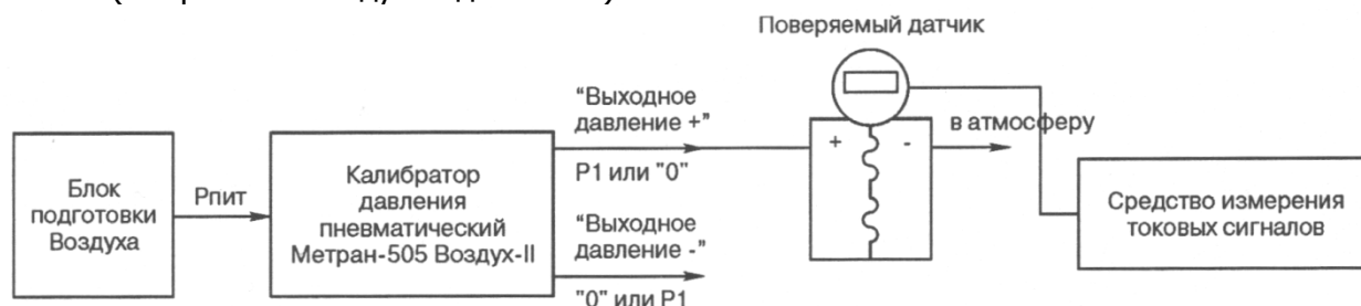
Рис.6. Схема подключения калибраторов Метран-505 Воздух-II, Метран-505 Воздух-I (с выключенным БОД) при поверке датчиков давления, разности давлений.
