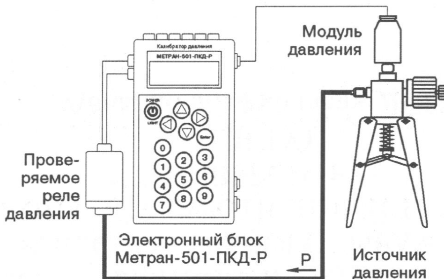
Рис.3. Проверка реле давления.
