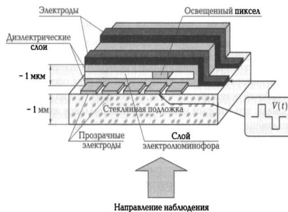
Рис. 4.9. Структура панели электролюминесцентного монитора
