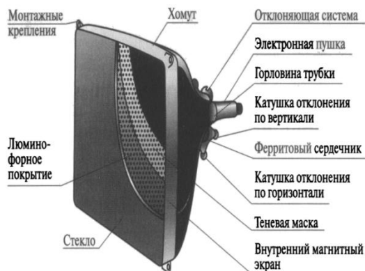
Рис. 4.1. Конструктивная схема ЭЛТ-монитора
