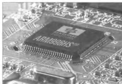
Рис. 2.1. Микропроцессор: транзисторы, резисторы, конденсаторы и соединяющие их проводники в одном кремниевом кристалле
