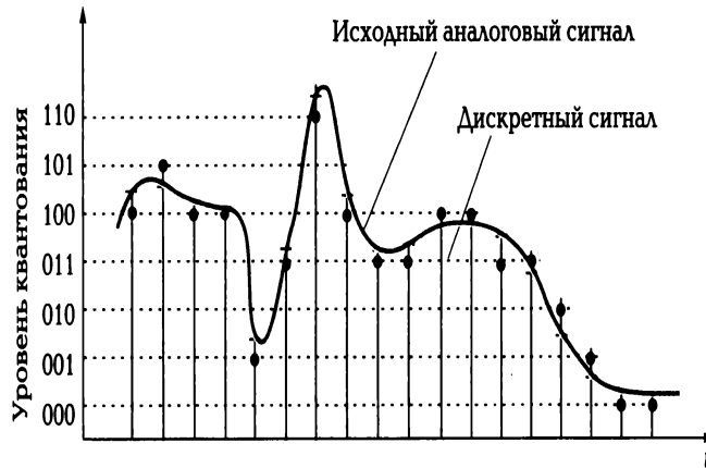
Рис. 5.3. Дискретизация по времени и квантование по уровню аналогового сигнала
