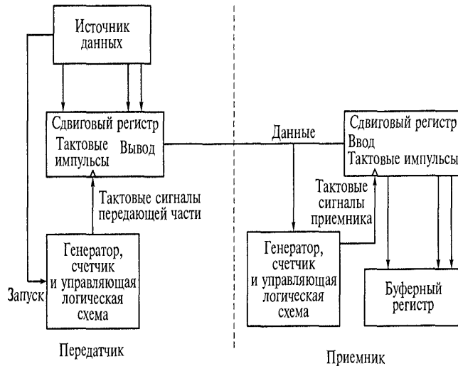
Рис. 13.6. Структурная схема асинхронной последовательной передачи данных
