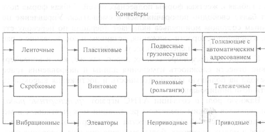
Рис. 2.29. Классификация основных типов конвейеров
