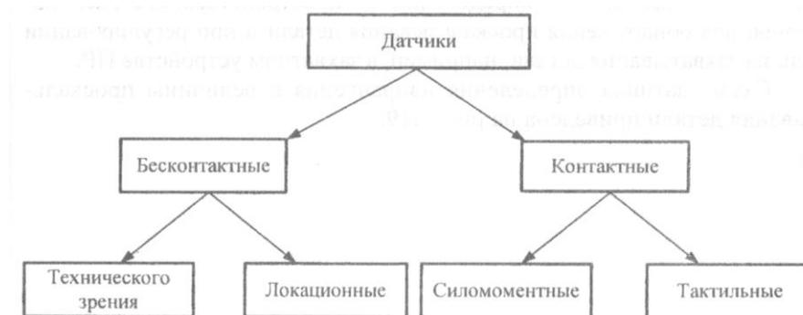
Рис. 2.17. Условная классификация датчиков
