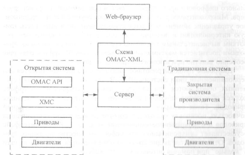
Рис. 2.7. Структура Web-доступа к системам с ЧПУ
