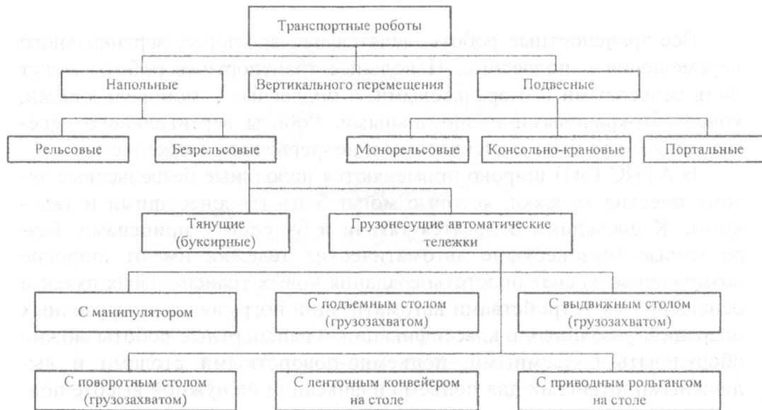
Рис. 2.30. Классификация транспортных роботов
