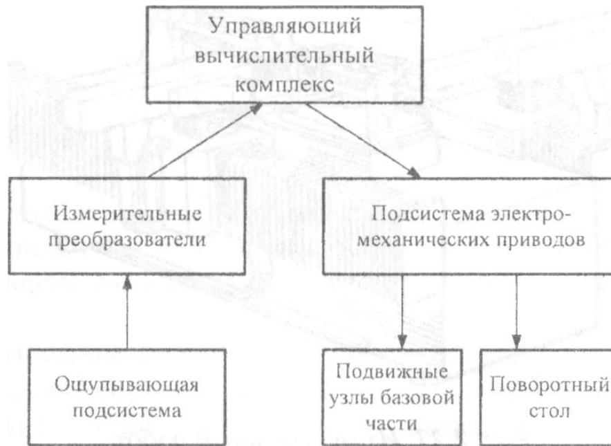
Рис. 2.22. Обобщенная схема КИМ
