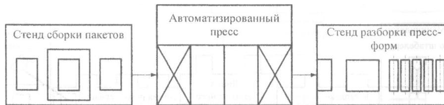
Рис. 2.52. Компоновка модуля прессования
