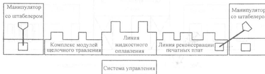
Рис. 2.50. Компоновка модуля щелочного травления
