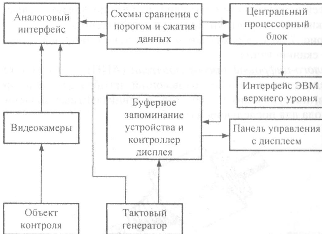
Рис. 2.21. Схема системы технического зрения
