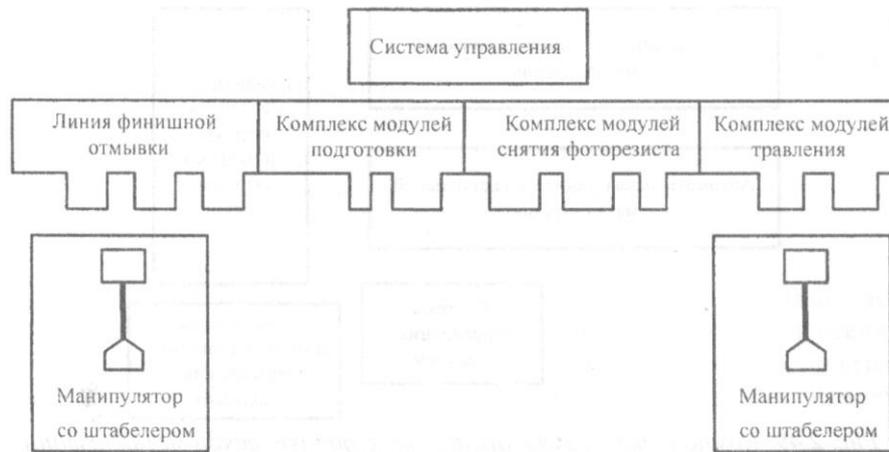
Рис. 2.51. Компоновка модуля кислотного травления
