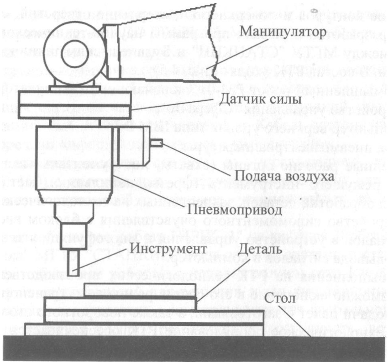
Рис. 4.6. Рабочий орган робота с силомоментным датчиком
