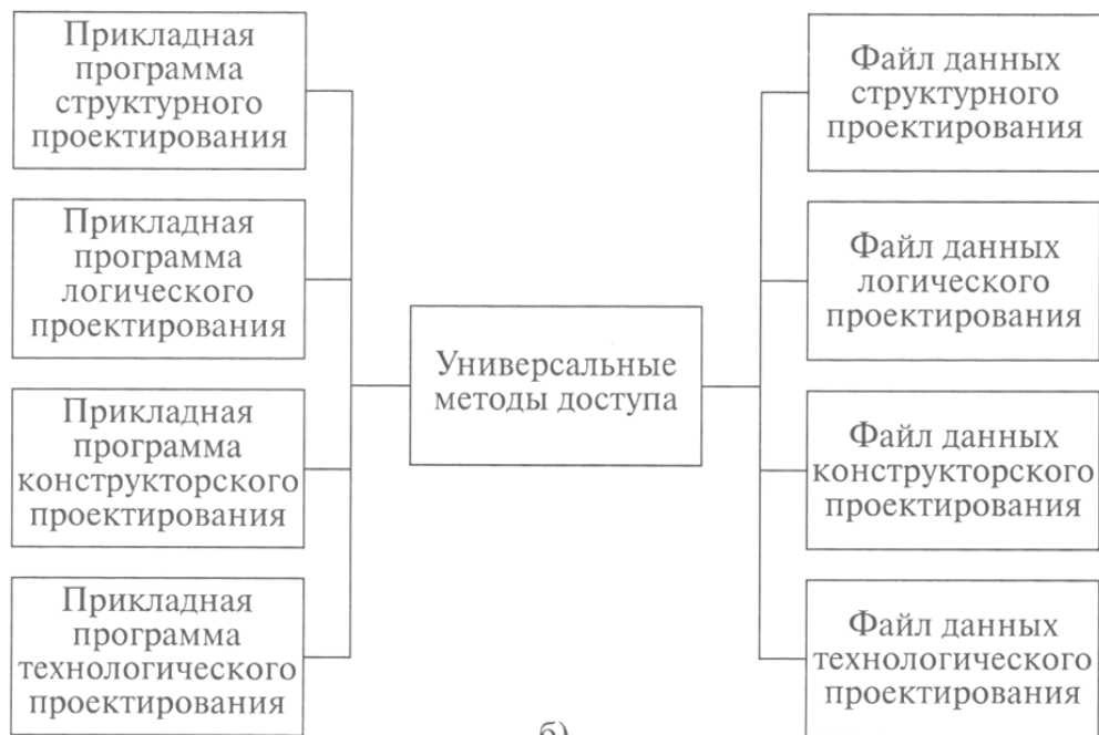
Рис. 8.32. Взаимнооднозначное соответствие между прикладными программами и файлом данных (а) и пример использования универсальных методов доступа (б)
