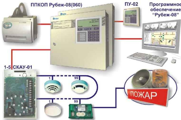
Рисунок 65 Подсистема адресно-аналоговой пожарной сигнализации в составе ИСБ «Рубеж»
