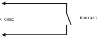
Рисунок 47 Схема включения ШС без контроля КЗ и обрыва
