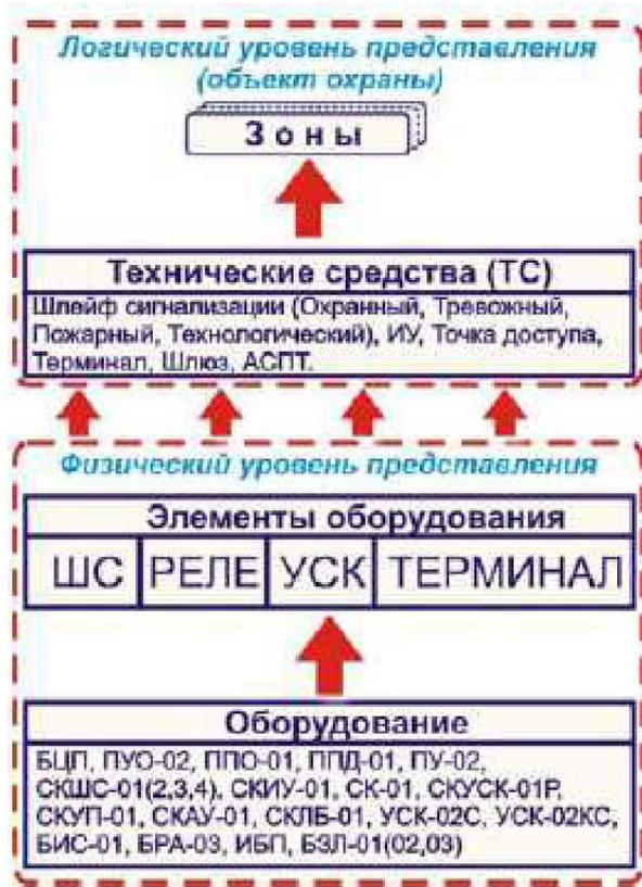
**Рисунок 72** Внутренняя архитектура конфигурации БЦП
