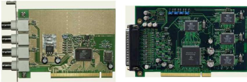
Рисунок 82 Платы видеоввода «RMVideo-4» и «RMVideo-16-50»
