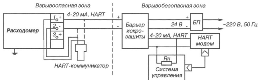
Рис.5. Вариант включения расходомера взрывозащищенного исполнения вида 0Exia с искрозащищенным блоком питания и HART-модемом.
