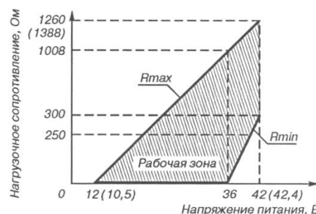
Для работы по HART-протоколу Rmin=250 Ом
