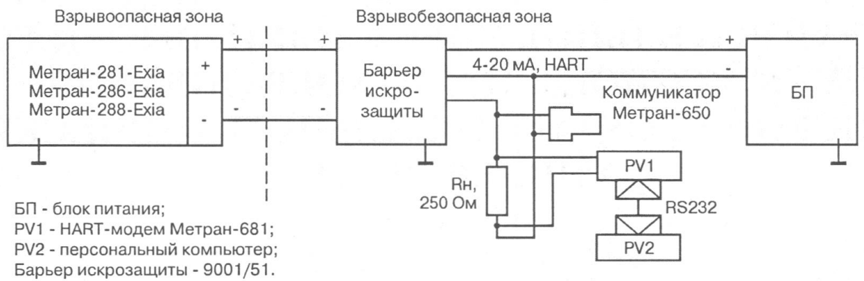
Рис.29. Метран-281 -Ехiа, -286-Ехiа, -288-Ехiа с барьером искрозащиты без гальванической развязки цепи питания и информационной цепи
