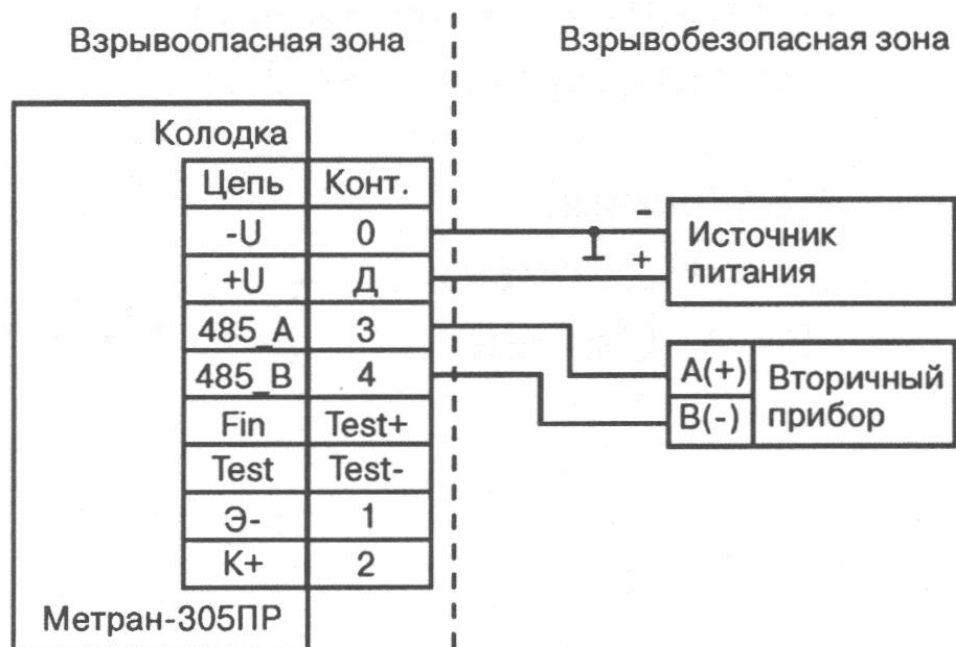
Рис.2. Схема подключения Метран-305ПР с токовым выходным сигналом к вторичному прибору.
