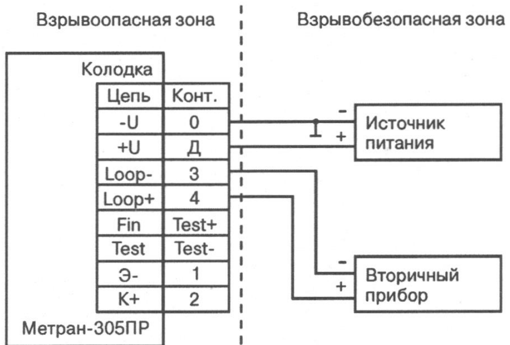
Рис.2. Схема подключения Метран-305ПР с токовым выходным сигналом к вторичному прибору.
