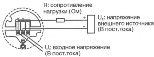
Рис. 19. Сигнал 4-20 мА/HART.
