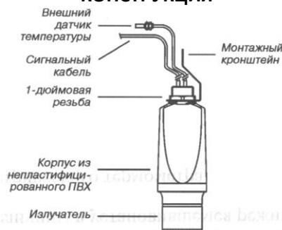
Рис.3. Конструкция уровнемера, модель 3108.
