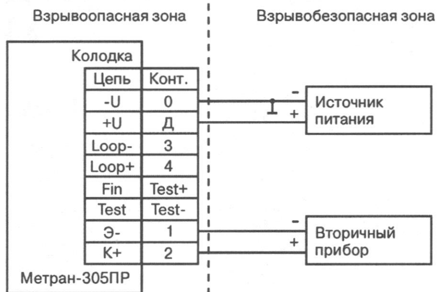
Рис. 1. Схема подключения Метран-305ПР с импульсным выходным сигналом к вторичному прибору.
