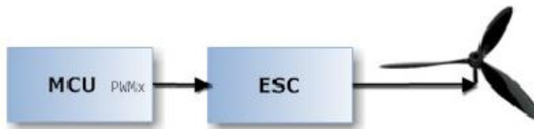
Рисунок 4 – Структурная схема подключения одного двигателя.
