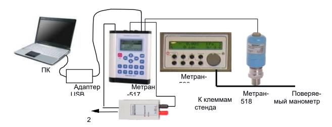
Рис. 3.80. Схема подключений при поверке манометра
