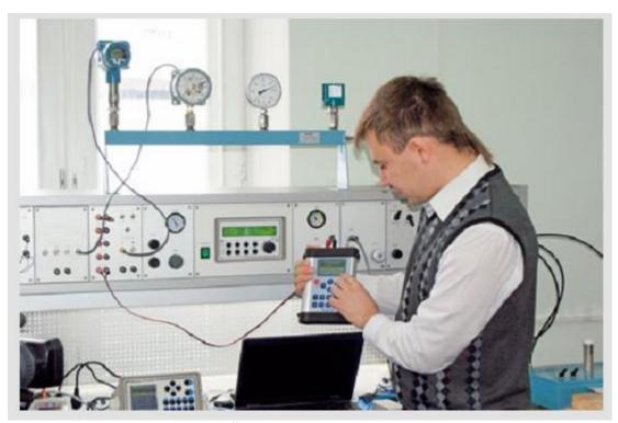
Рис. 3.94. Лабораторный стенд с окном просмотра протокола поверки
