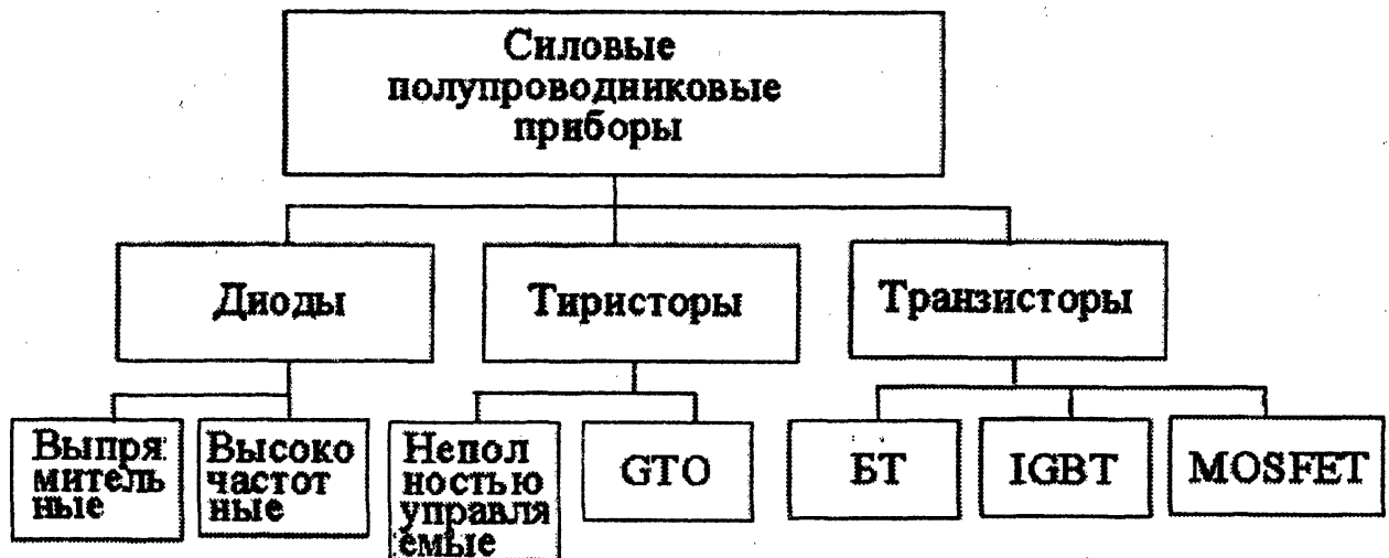
Рис. 4.35. Классификация силовых полупроводниковых элементов
