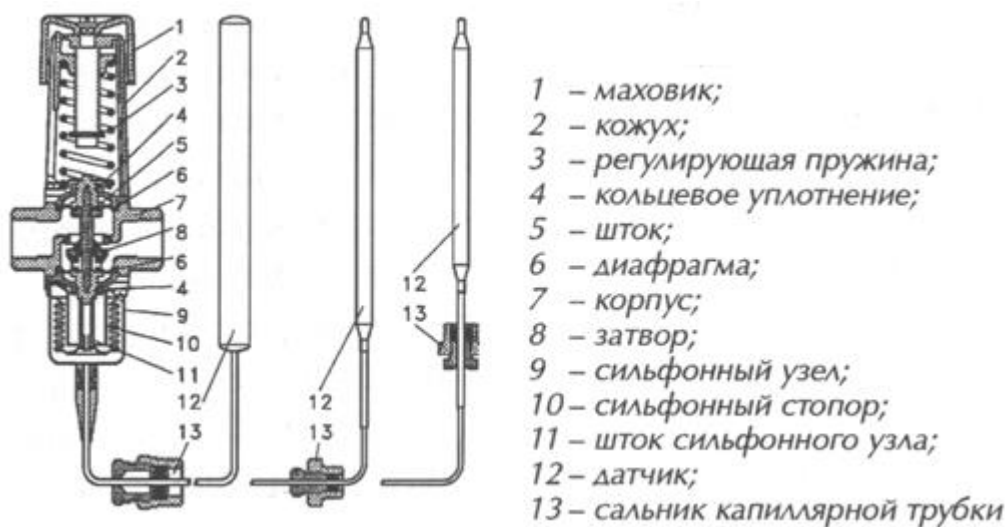
Рис. 3.7 Устройство регулятора температуры AVTB
