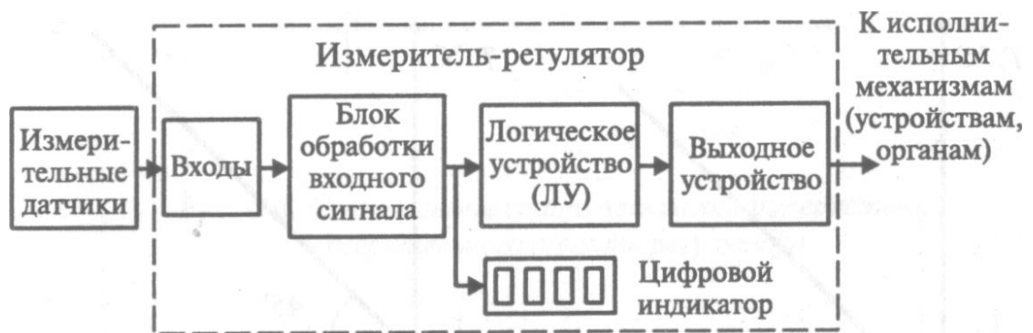
Рис. 2.2. Обобщенная функциональная схема измерителя-регулятора типа ТРМ
