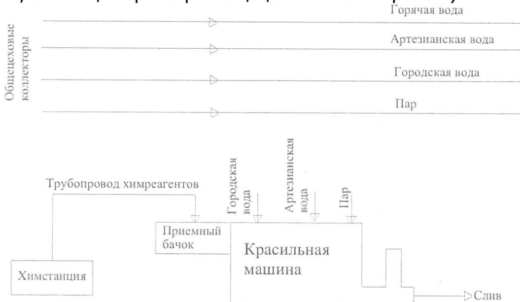
Рис. 1. Принципиальная схема красильной машины.
