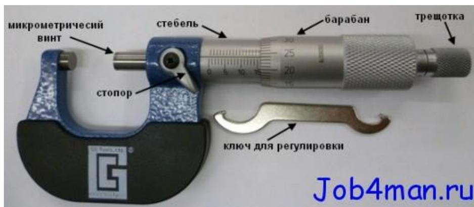
**Микрометр** – измерительный прибор очень высокой точности. Применяется в различных областях производства для измерения высокоточных деталей. Погрешность прибора очень мала, составляет от 2-9 мкм (микрометров).  $0,1\text{мм} = 100\text{мкм}$  (один микрометр в сто раз меньше десятой доли миллиметра). 1мкм – миллионная доля метра. Что намного меньше, чем у [штангенциркуля](#).
