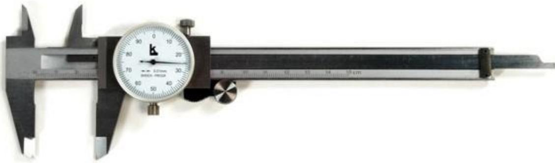
Данный вид штангенциркулей оснащен круговой шкалой, которая выполнена в виде поворотного индикатора с ценой деления 0,02 мм. ШЦК-I удобны при проведении частых сравнительных измерений, индикаторная стрелка удобна для быстрого считывания результатов, исключается возможность скачков, чем иногда грешат цифровые аналоги. Очень удобно использовать данный тип штангенциркуля для контроля одних и тех же типовых размеров деталей.
