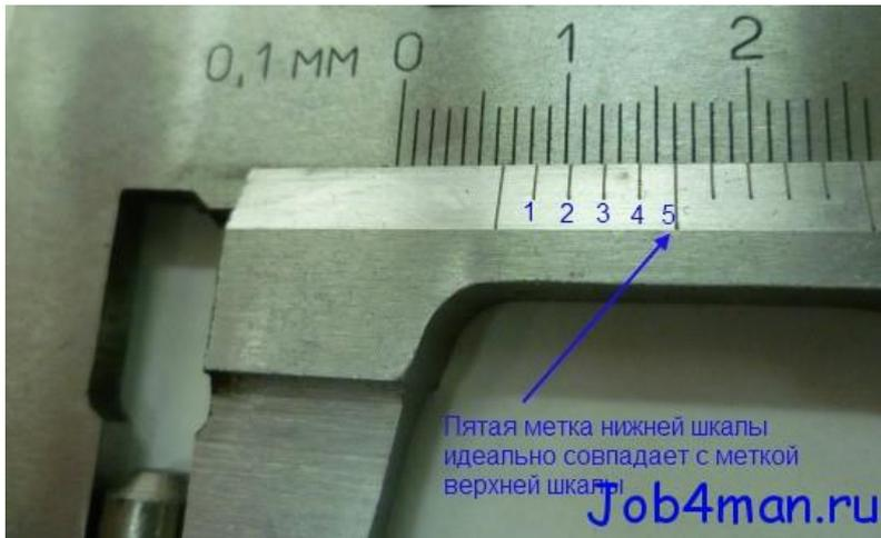
Далее рассмотрим, как измерять внутренний диаметр. Сверху есть две заостренные губки, вставляем их между внутренними стенками трубы, к примеру, далее смотрим значения нижней метки, точно так же, как при измерении размера сверла (пример выше).
