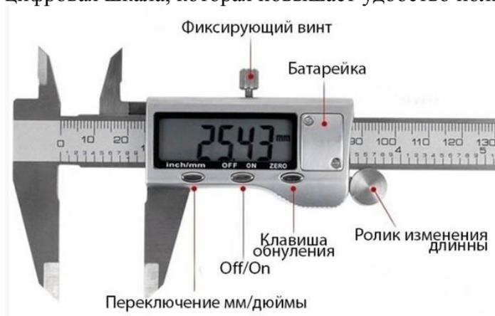
Как и любой измерительный инструмент, штангенциркуль имеет шкалу делений (цена деления 0,01 означает, что инструмент измеряет размер с точностью до сотой миллиметра) и погрешность измерения. Приемлемой погрешностью считается погрешность до 10% от точности измерения инструмента. На производстве все штангенциркули регулярно один раз в 6 месяцев проходят метрологическую поверку.
