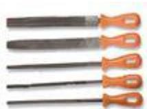
**Напильники** представляют собой стальные закаленные бруски, на рабочих поверхностях, которых нанесено большое количество насечек или нарезок, образующих режущие зубья напильника. Эти зубья обеспечивают срезание с поверхности заготовки небольшого слоя металла в виде стружки.
