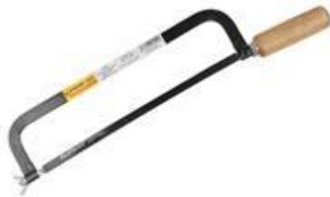
**Ручные слесарные ножовки** предназначены в основном для разрезания сортового и профильного проката вручную, а также для разрезания толстых листов и полос, прорезания пазов в головках винтов, обрезания заготовок по контуру и других работ. Наиболее распространенные ножовочные полотна шириной 13 и 16мм. При толщине от 0,5 до 0,8мм и длиной 250-300мм. Ножовочные станки бывают двух типов: цельные и раздвижные, позволяющие устанавливать в станок ножовочное полотно разной длины.
