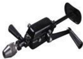
**Ручная дрель** предназначена для сверления отверстий вручную. При работе ручной дрелью сверло закрепляют в патроне, левой рукой берут неподвижную рукоятку, а правой – подвижную. Упираясь грудью в упор-нагрудник, правой рукой вращают ручку дрели. Через зубчатую передачу сверлу сообщается вращательное движение. При работе необходимо следить за тем, чтобы сверло направлялось точно по оси обрабатываемого отверстия.
