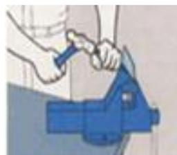
**Горизонтальную рубку** выполняют в тисках. Зубило при этом держат почти горизонтально под углом не более 5° к плоскости губок тисков.
