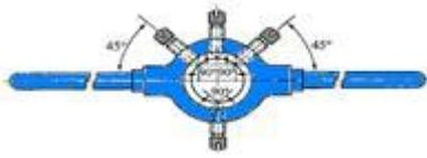
**Раздвижные плашки** устанавливают в клуппе согласно цифрам на плашке и раме клуппа. Между плашкой и упорным винтом необходимо поместить пластину-сухарь, чтобы при нажиме винтом плашка не лопнула.
