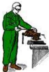
**Опиливание**— это операция по удалению с поверхности заготовки слоя материала при помощи режущего инструмента – напильника, целью которой является придание заготовке заданных формы и размеров, а также обеспечение заданной шероховатости поверхности.
