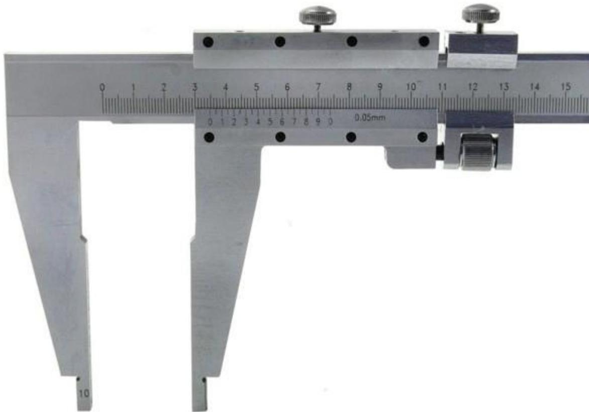
Данный тип штангенциркулей предназначен для измерения больших деталей с высокой точностью. Максимальный размер измерений может составлять от 450 до 5000 мм. У ШЦ-III, ШЦЦ-III губки направлены только вниз, их длину можно заказать от 100 до 300 мм, что позволяет измерять детали в широком диапазоне. Цена деления составляет 0,01 мм у цифровых штангенциркулей и 0,02 мм - у механических.
