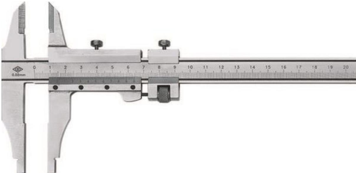
Эта серия инструментов применяется для контроля внешних и внутренних размеров. Диапазон измерений от 0 до 250-300 мм с ценой деления 0,02 и 0,05 мм. ШЦ-II используют чаще для проведения разметочных работ, по этой причине они оснащаются специальными твердосплавными насадками, которые защищают губки инструмента от быстрого износа.
