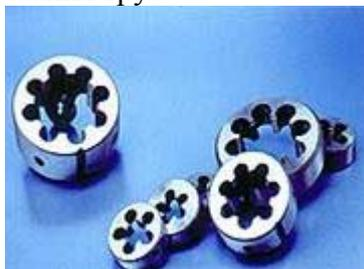
**Круглые плашки (лерки)** представляют собой резьбовое кольцо с несколькими канавками для образования режущих кромок и вывода стружки при нарезании резьбы.
