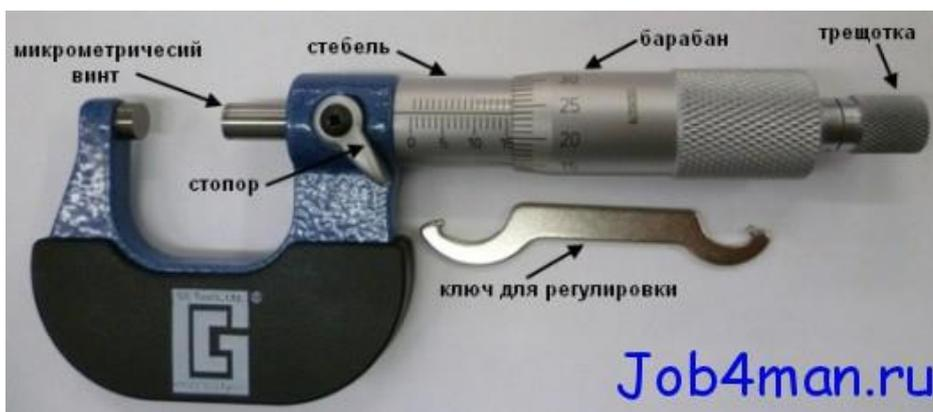
**Микрометр** – измерительный прибор очень высокой точности. Применяется в различных областях производства для измерения высокоточных деталей. Погрешность прибора очень мала, составляет от 2-9 мкм (микрометров). 0,1мм = 100мкм (один микрометр в сто раз меньше десятой доли миллиметра). 1мкм – миллионная доля метра. Что намного меньше, чем у [штангенциркуля](#).
