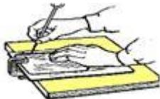
Чтобы ускорить и упростить плоскостную разметку одинаковых изделий применяют шаблоны из листовой стали.
