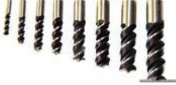
\* при выборе диаметра сверла следует учитывать его вибрацию в патроне, в результате чего отверстие получается несколько большего диаметра, чем сверло. Отклонение это достаточно мало – от 0,05 до 0,3мм – и имеет значение в том случае, когда требуется особая точность;
