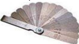
**Щупы** представляют собой набор пластин определенной толщины. Щупы являются нормальными калибрами при проверке зазоров между поверхностями, они выпускаются с номинальными размерами 0,02...1,0мм, с градацией через 0,01 и 0,05мм. По длине различают щупы двух исполнений: 200 и
