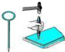
**По предварительной разметке** (выполненной разметочным инструментом), по разметке сверлят одиночные отверстия. Предварительно на деталь наносят осевые риски, затем кернят углубления в центре отверстия. Керновое отверстие окружности делают глубже, чтобы дать предварительное направление сверлу. Сверление осуществляют в два приема – сначала выполняют пробное сверление, а затем окончательное.
