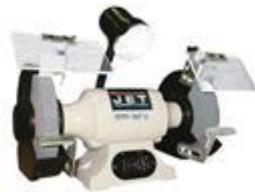
**Заточка режущего инструмента** осуществляется на заточных станках с абразивными кругами. Во время заточки рабочая часть инструмента (лезвие) сильно нагревается и может произойти ее отпуск. При отпуске твердость закалки теряется и инструмент становится негодным для дальнейшей работы. Во избежание этого рабочую часть инструмента во время заточки охлаждают водой.
