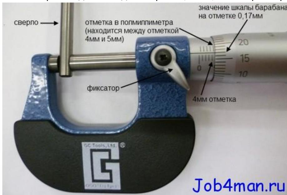
Микрометр имеет фиксатор, он позволяет зафиксировать размер детали и сравнить его с другой такой же деталью.
