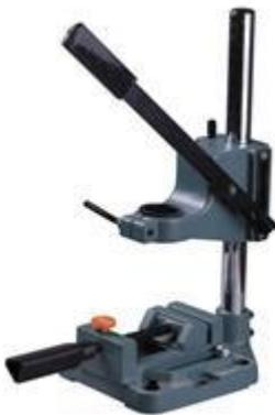
Необходимо прочно закреплять сверло с коническим хвостовиком (патрон со сверлом) в шпинделе станка.
