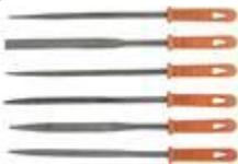
**Рашпили** по форме поперечного сечения могут быть плоские тупоконечные, плоские остроконечные, круглые и полукруглые.
