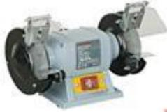
\* затупленные режущие инструменты не только образуют некачественные отверстия, но и сами быстрее выходят из строя, поэтому их следует своевременно затачивать: сверла – под углом (в вершине) 116-118°, конические зенкеры – 60, 90, 120°. Заточку производят вручную на заточном станке: сверло приставляют к кругу заточного станка одной из режущих кромок под углом 58-60° и плавно поворачивают его вокруг своей оси, затем таким же образом затачивают вторую режущую кромку.
