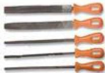
**Напильники** представляют собой стальные закаленные бруски, на рабочих поверхностях, которых нанесено большое количество насечек или нарезок, образующих режущие зубья напильника. Эти зубья обеспечивают срезание с поверхности заготовки небольшого слоя металла в виде стружки.
