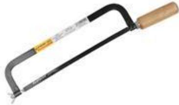
**Ручные слесарные ножовки** предназначены в основном для разрезания сортового и профильного проката вручную, а также для разрезания толстых листов и полос, прорезания пазов в головках винтов, обрезания заготовок по контуру и других работ. Наиболее распространенные ножовочные полотна шириной 13 и 16мм. При толщине от 0,5 до 0,8мм и длиной 250-300мм. Ножовочные станки бывают двух типов: цельные и раздвижные, позволяющие устанавливать в станок ножовочное полотно разной длины.
