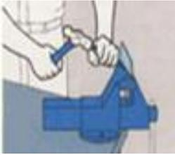
**Горизонтальную рубку** выполняют в тисках. Зубило при этом держат почти горизонтально под углом не более  $5^\circ$  к плоскости губок тисков.
