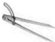
**Циркуль разметочный** применяется для вычерчивания окружностей, дуг и различных геометрических построений, а также для перенесения размеров с линейки на разметочную заготовку или наоборот. Различают циркули реечные, рейсмусовые, кронциркули, нутромерные, штангенциркули
