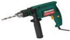
· перед началом сверления необходимо проверить работу дрели на холостом ходу, а также убедиться в отсутствии биения сверла. При необходимости сверло следует либо заменить, либо закрепить заново.
