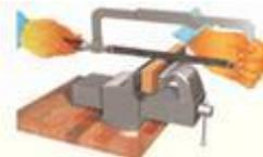
5. В том случае, если длина реза на детали превышает размер от полотна до рамки ножовочного станка, резание необходимо производить полотном, закрепленным перпендикулярно плоскости ножовочного станка (ножовкой с повернутым полотном).
