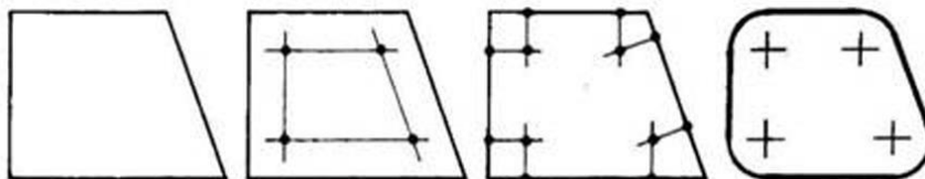
Рис. 2. Сопряжение углов на примере построения проекции боковой стенки хлебницы
