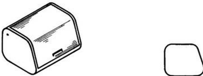
Рис. 1. Примеры плавного соединения поверхностей хлебницы и линий на проекции ее боковой стенки
