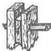
Соединение досок в щите деревянным нагелем
