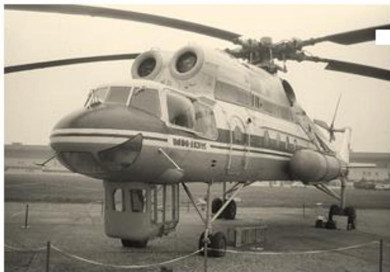
Рис. 2.4. Вертолет-кран Ми-10К с дополнительной нижней кабиной для координации процесса монтажа конструкций
