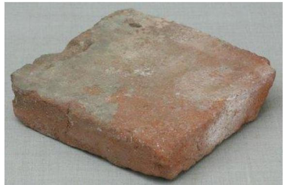
*Рис. 13 - Плита керамическая (плинфа). Втор. пол. XVI - XVII в. Соловецкий монастырь. Кирпичный завод. Керамическая масса, формовка, обжиг. 19,5 x 20,0 x 4,6*
