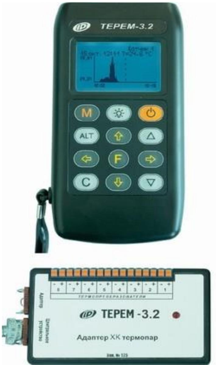
Многоканальный контроль и регистрация процессов изменения температуры монолитного бетона при выдерживании и электропрогреве.
